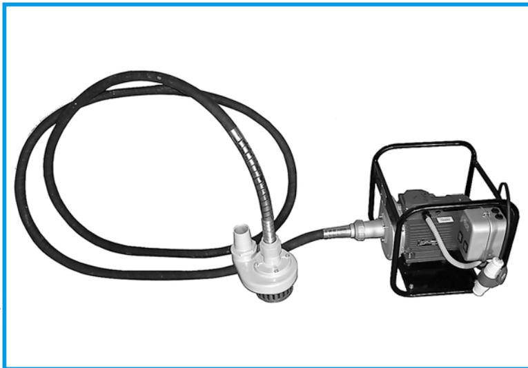
В качестве привода может использоваться несколько типов двигателей: четырехтактный бензиновый, дизельный, пневматический или электродвигатель. Насосная часть очень проста по конструкции, изготовлена из высокопрочных материалов и снабжена рабочим колесом вихревого типа специальной конструкции, которое обеспечивает перекачивание жидкостей с размерами твердых частиц до 28 мм и так же **грязи с содержанием твердых частиц до 60%**.
