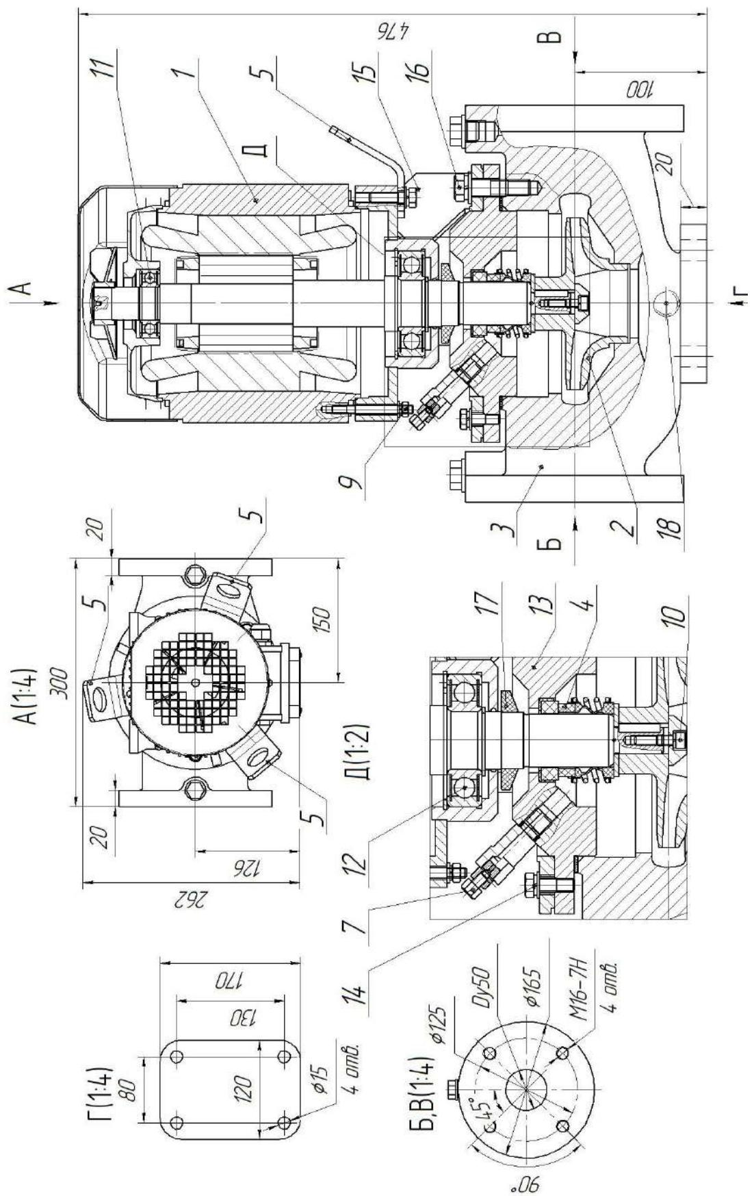
Приложение 1. Рисунок 2. Общий вид, габаритные и присоединительные размеры электронасоса серии «Иртыш» ЦМЛ 50/122-1,5/2.
