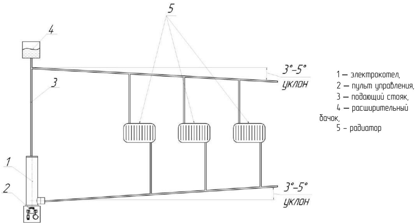
Рис. 5. Примерная схема отопления с естественной циркуляцией жидкости
