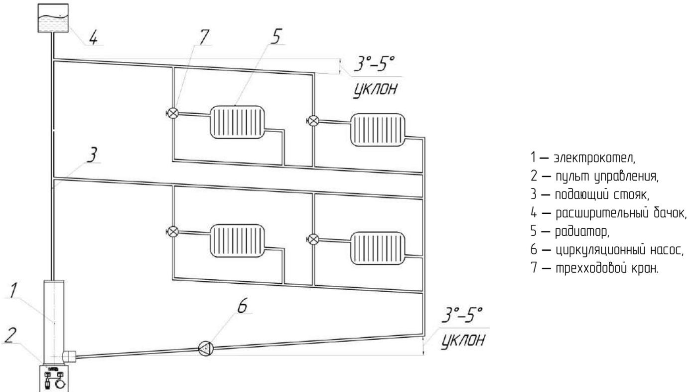
Рис. 6. Примерная схема поэтажного отопления с циркуляционным насосом
