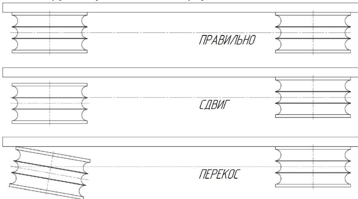
Рисунок 7.1 – Центровка шкивов
