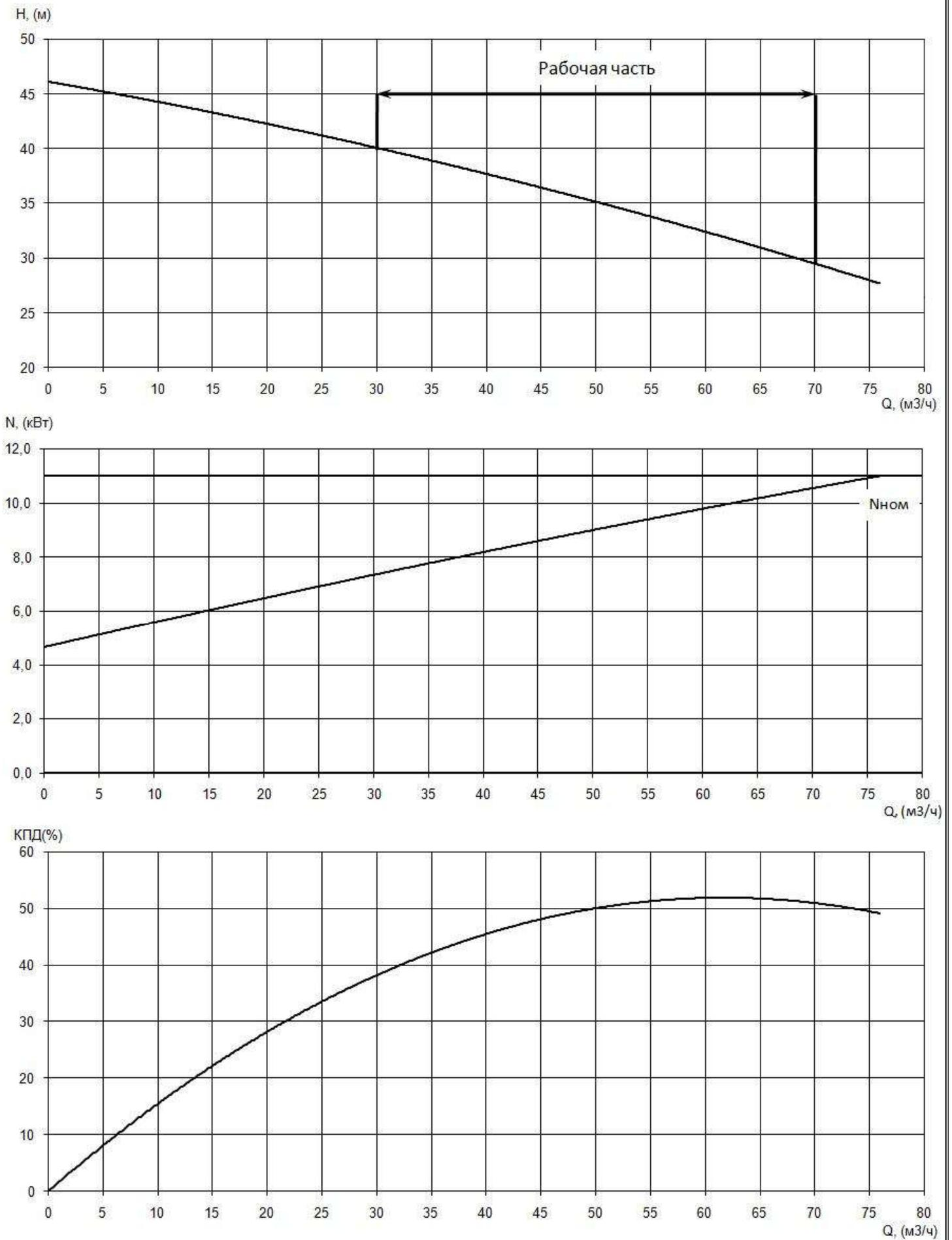
Рисунок 1. - Пример характеристики электронасоса серии «Иртыш»
