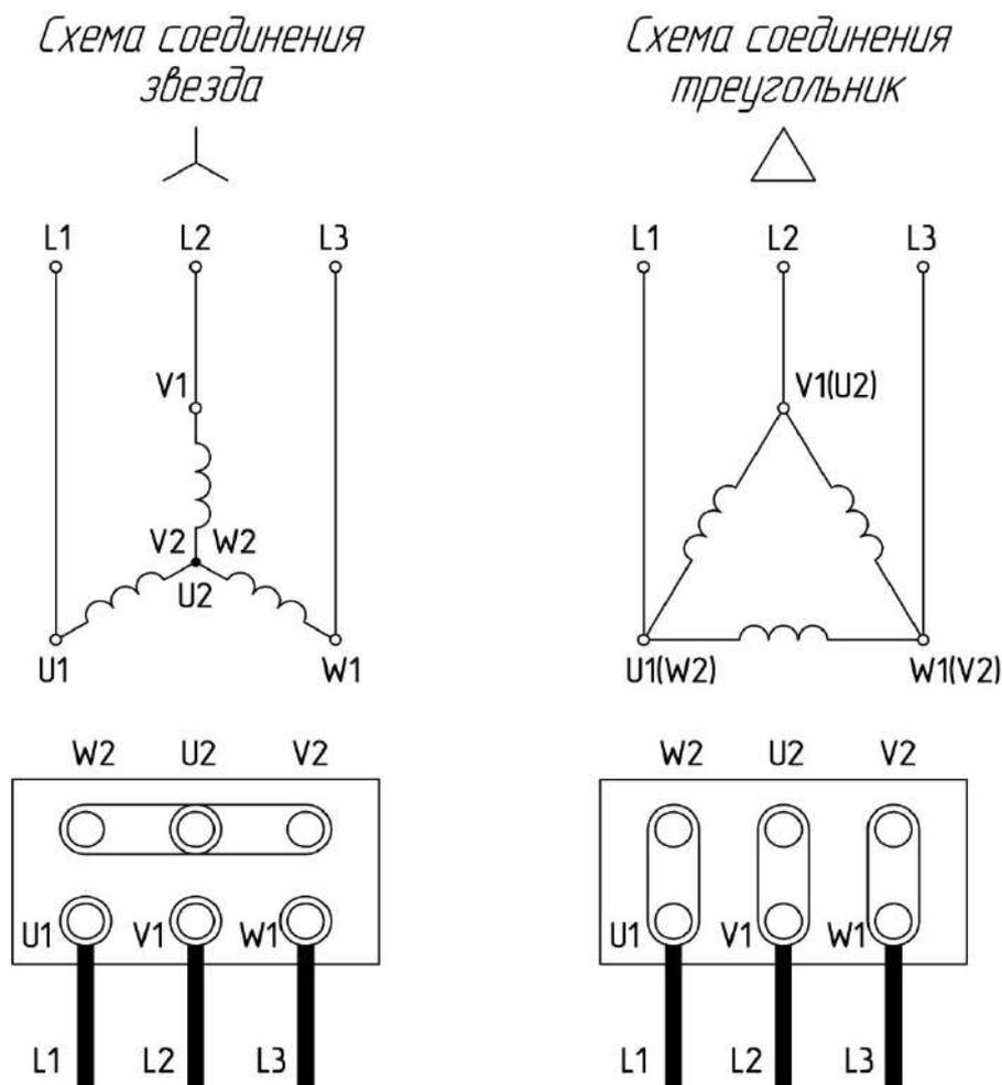
Рисунок 4. - Схемы подключения питания для трехфазного асинхронного электродвигателя
