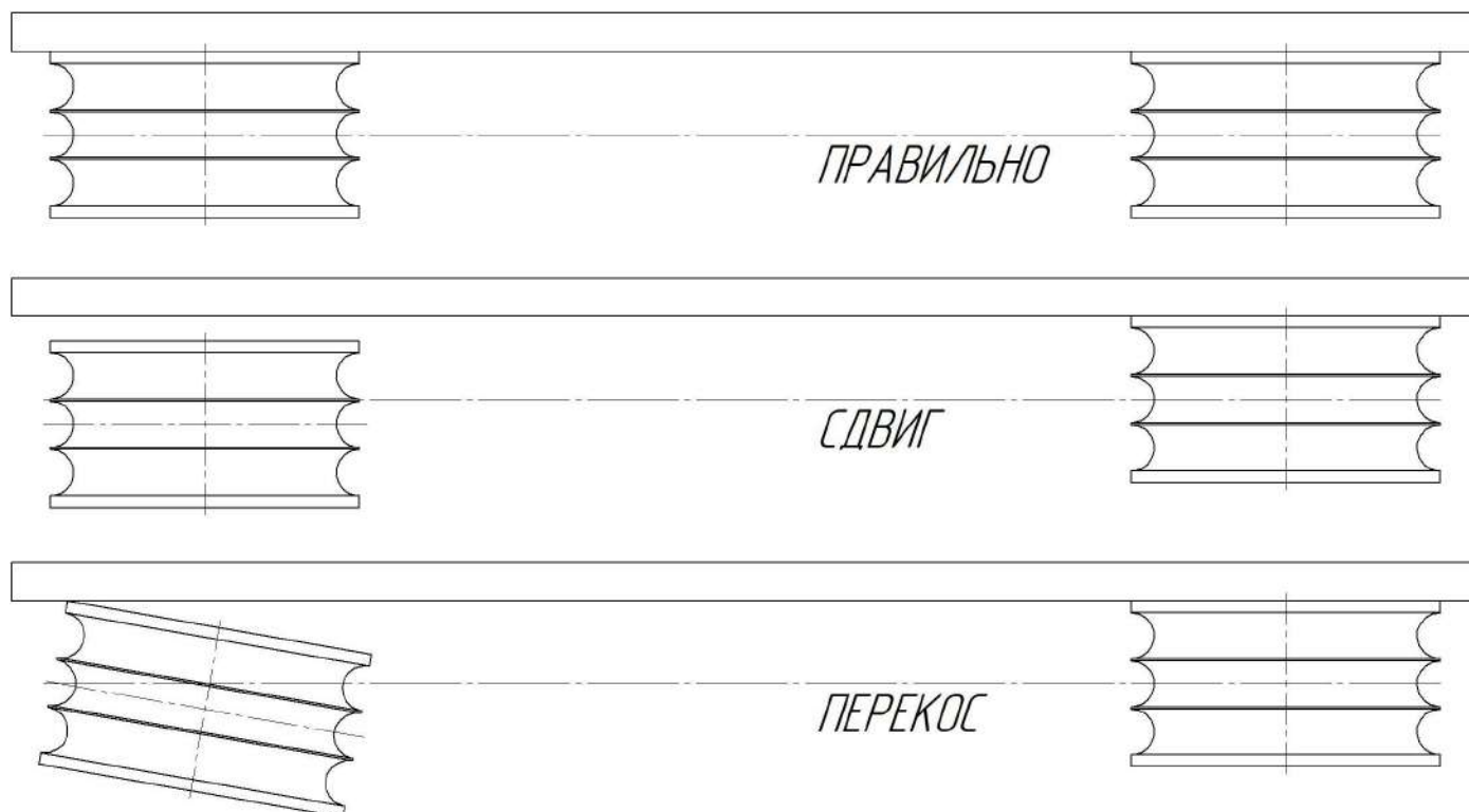
Рисунок 10 – Центровка шкивов
