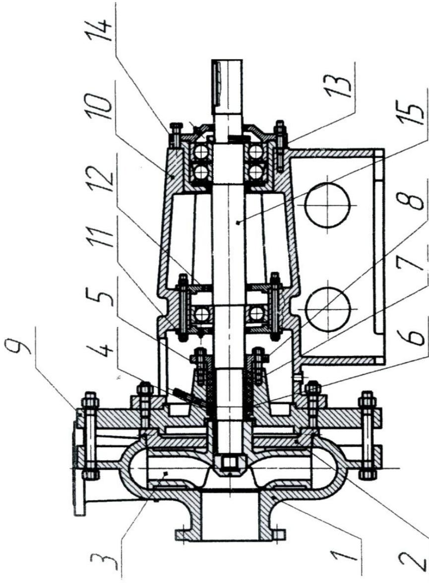
1. Корпус насоса, 2. Диск защитный, 3. Колесо рабочее, 4. Втулка сальника
