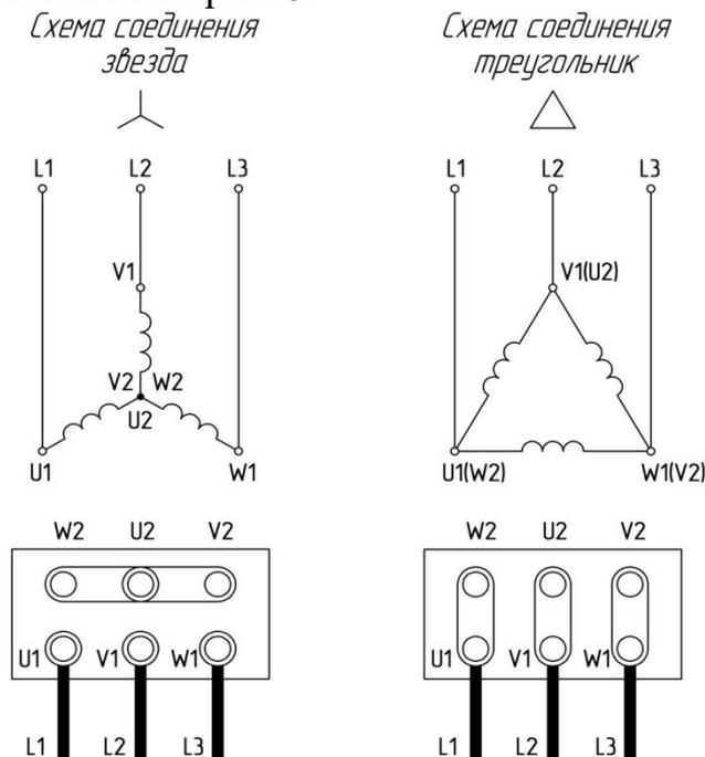
Рис. 3 Схемы подключения питания для трехфазного асинхронного двигателя
