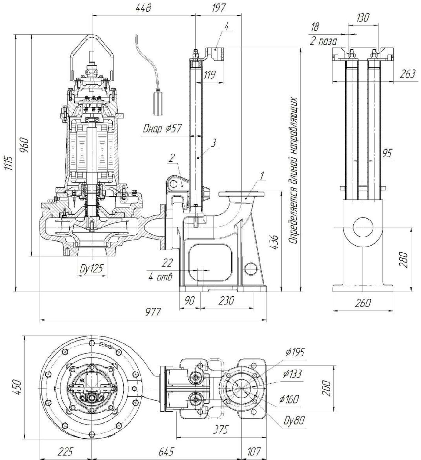
Рис.50 Общий вид и габаритные размеры электронасоса "Иртыш"
