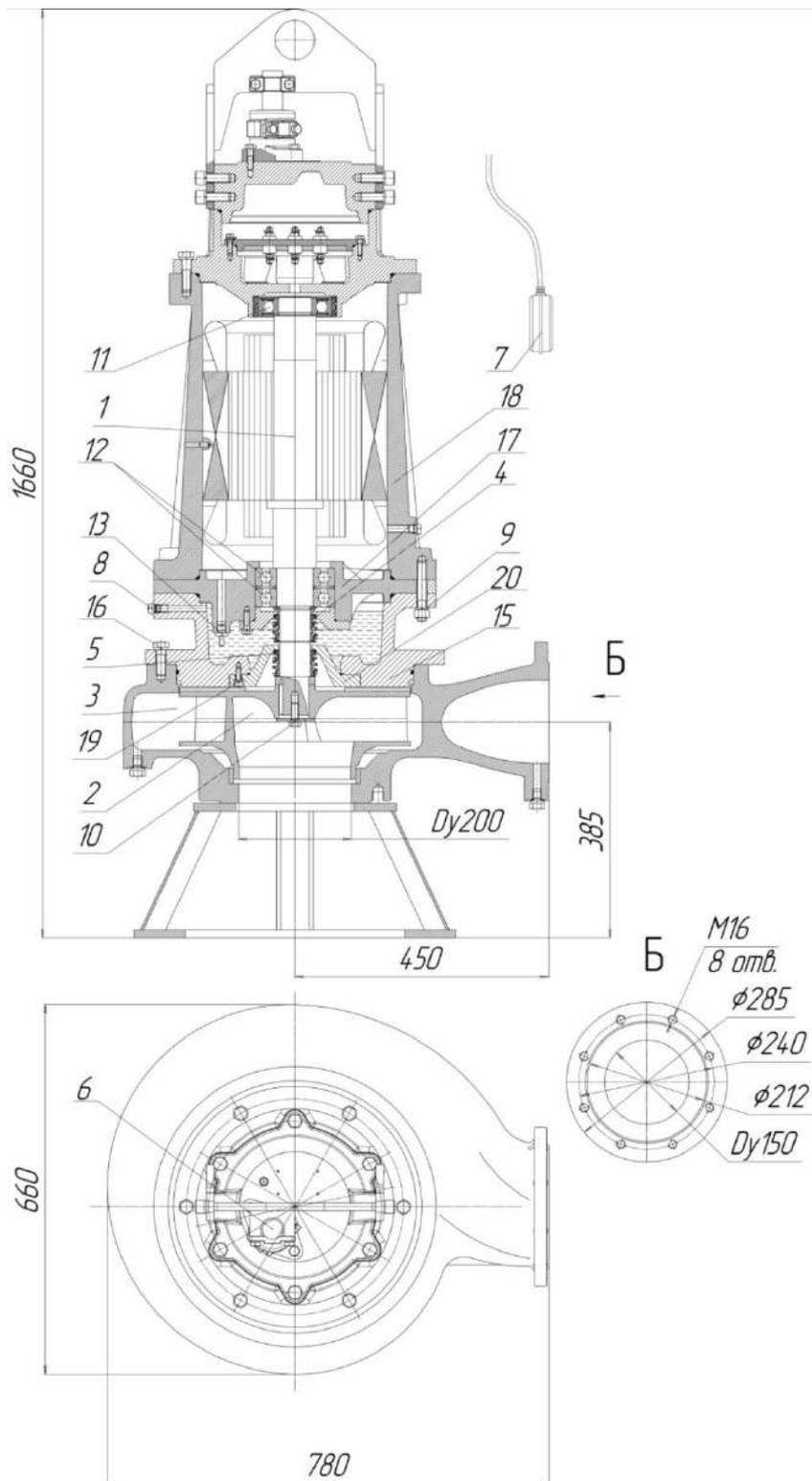
Рис.90 Общий вид, габаритные и присоединительные размеры электронасоса
