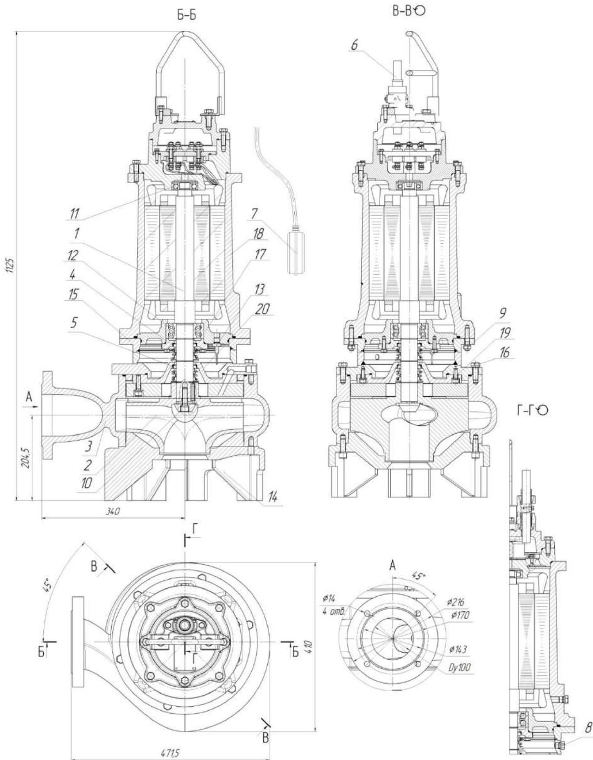
Рис.65 Общий вид, габаритные и присоединительные размеры электронасоса
