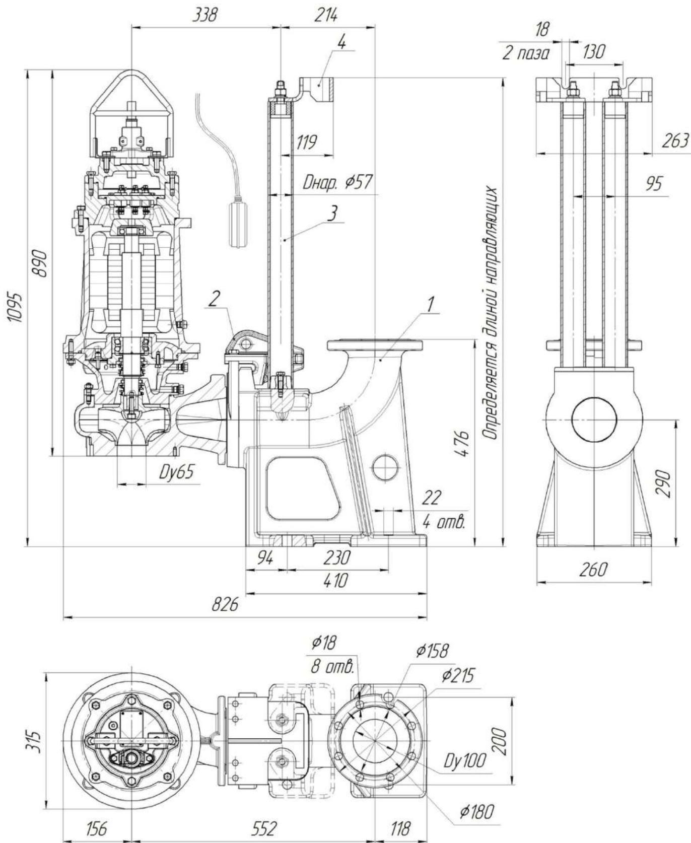
Рис.62 Общий вид и габаритные размеры электронасоса "Иртыш"
