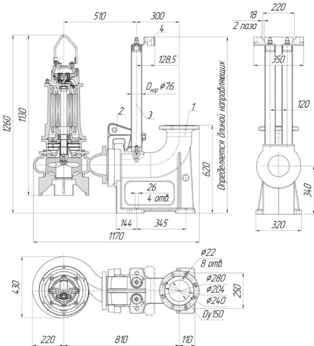
Рис.85 Общий вид и габаритные размеры электронасоса "Иртыш"
