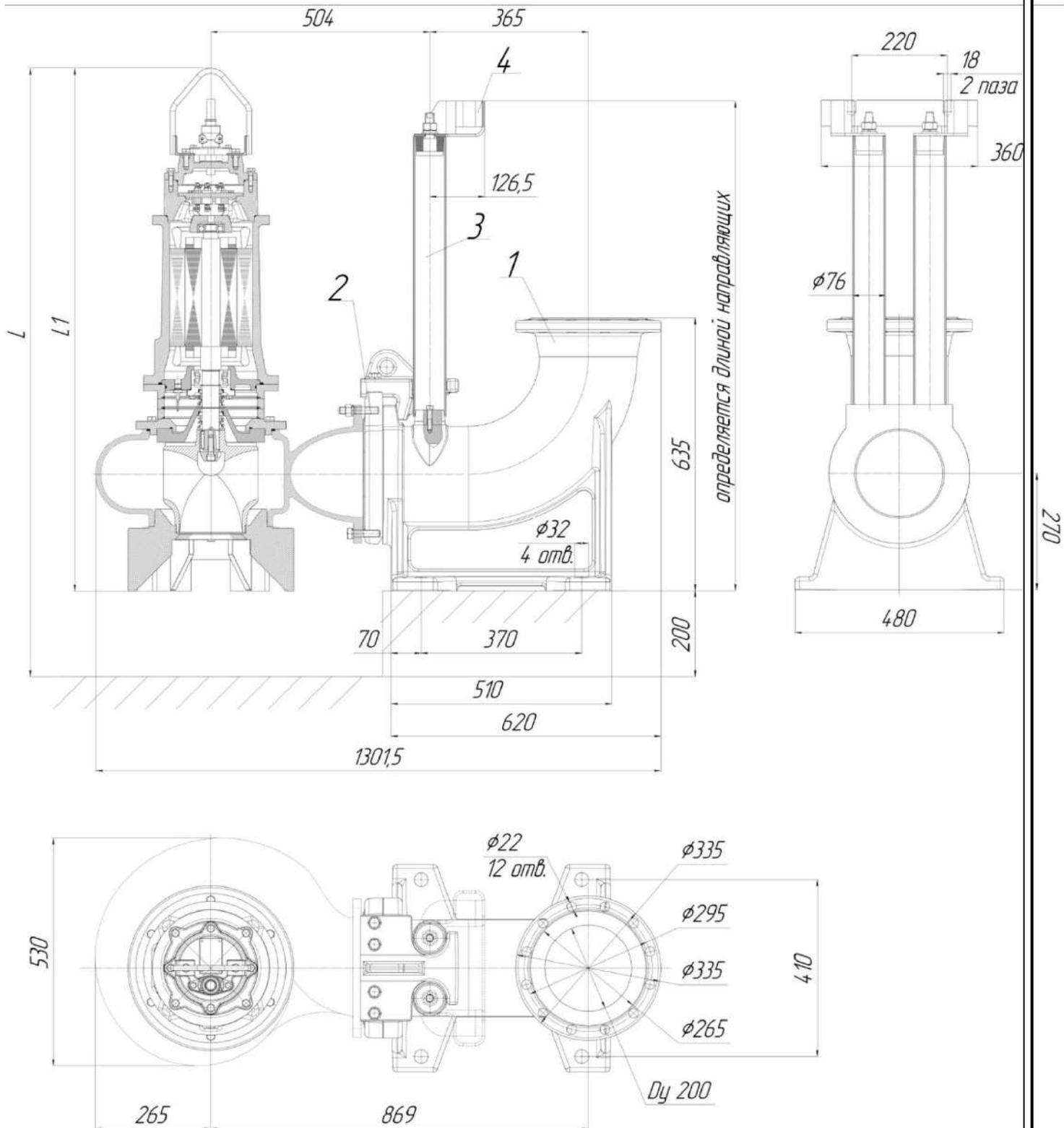
Рис.95 Общий вид и габаритные размеры
