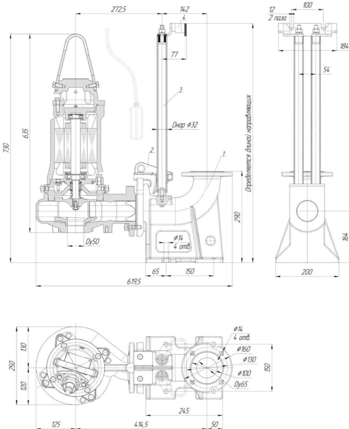
Рис.34 Общий вид и габаритные размеры электронасоса
