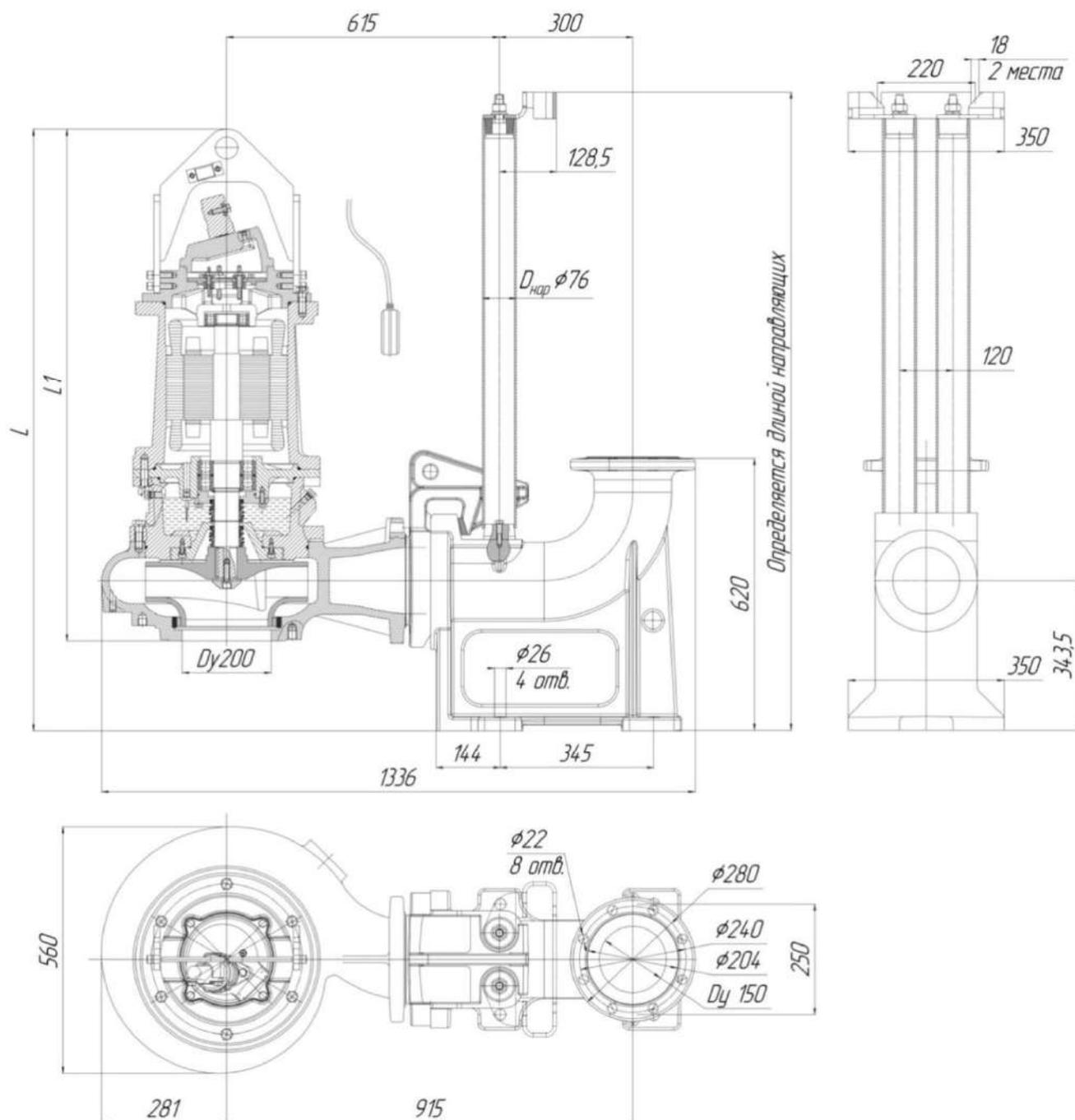
Рис.87 Общий вид и габаритные размеры
