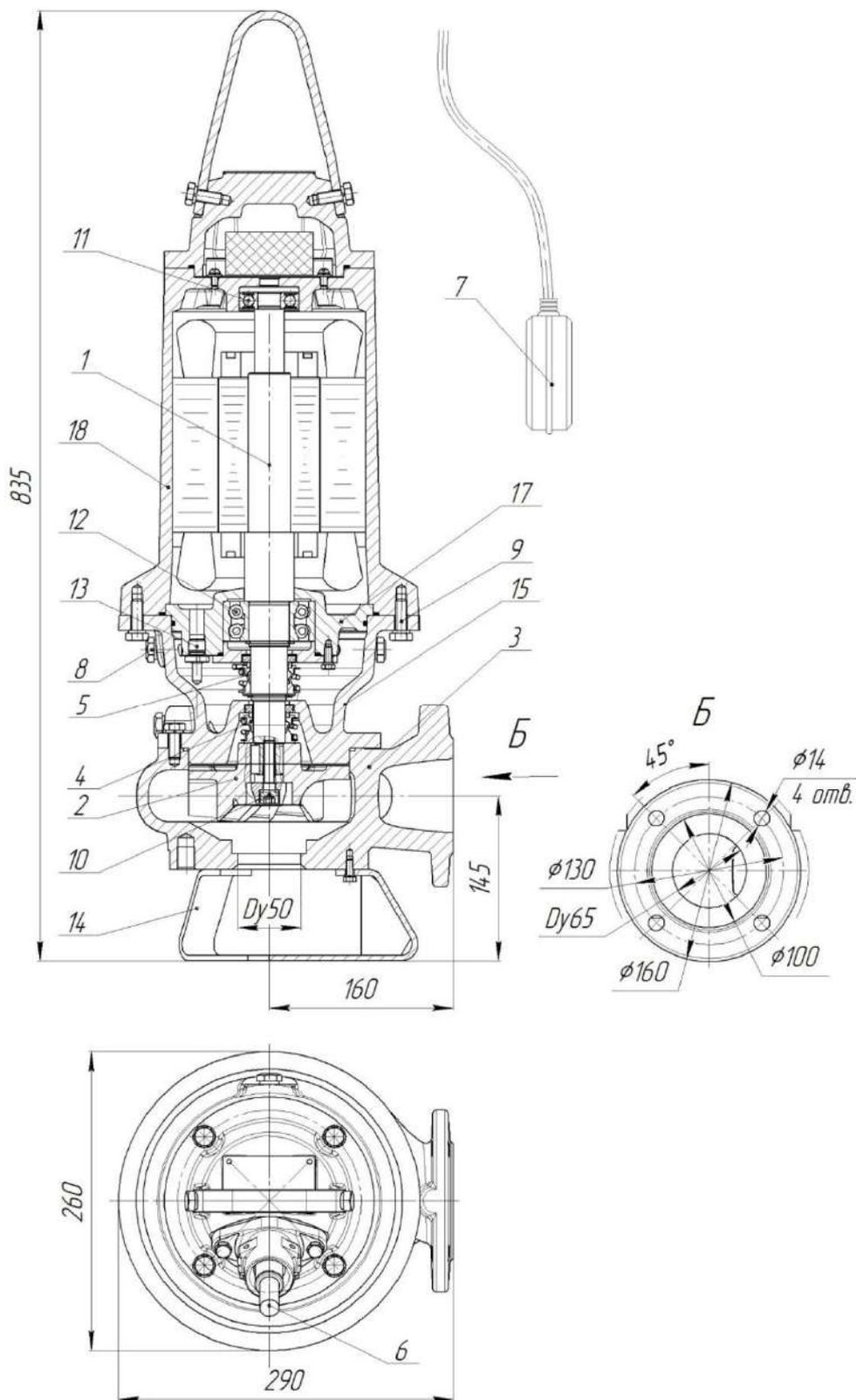
Рис.29 Общий вид, габаритные и присоединительные размеры электронасоса
