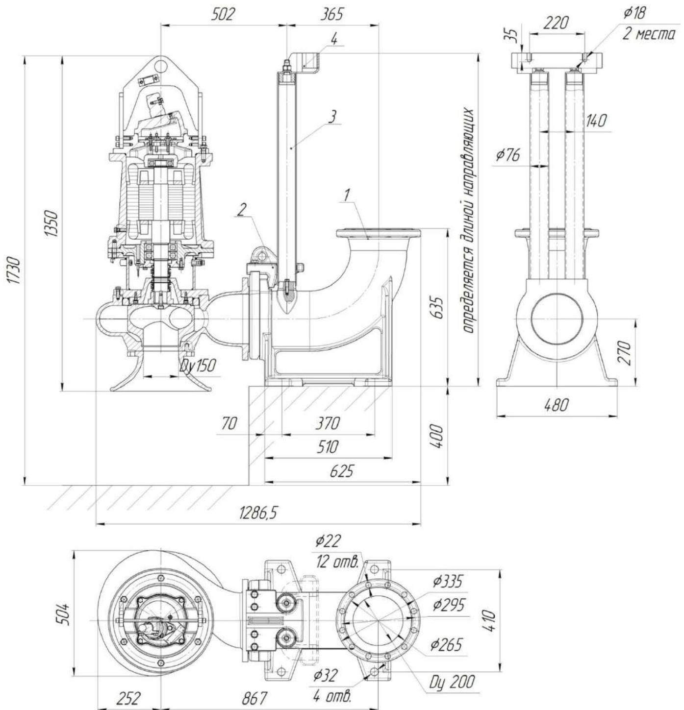
Рис.97 Общий вид и габаритные размеры электронасоса "Иртыш"
