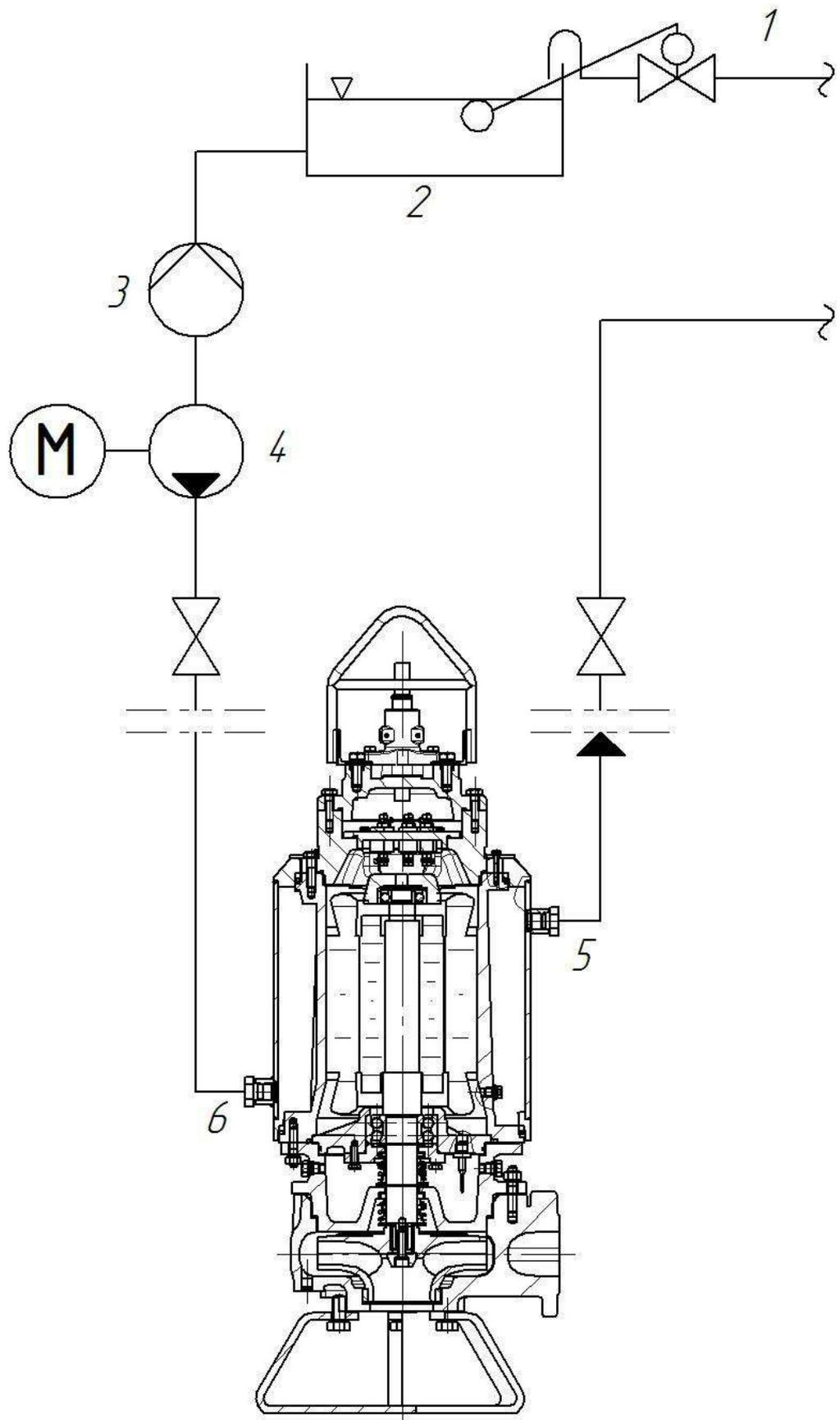
Рис 9. Рекомендуемая схема подачи охлаждающей воды для системы разомкнутого типа (подключение от внешнего источника охлаждающей жидкости).
