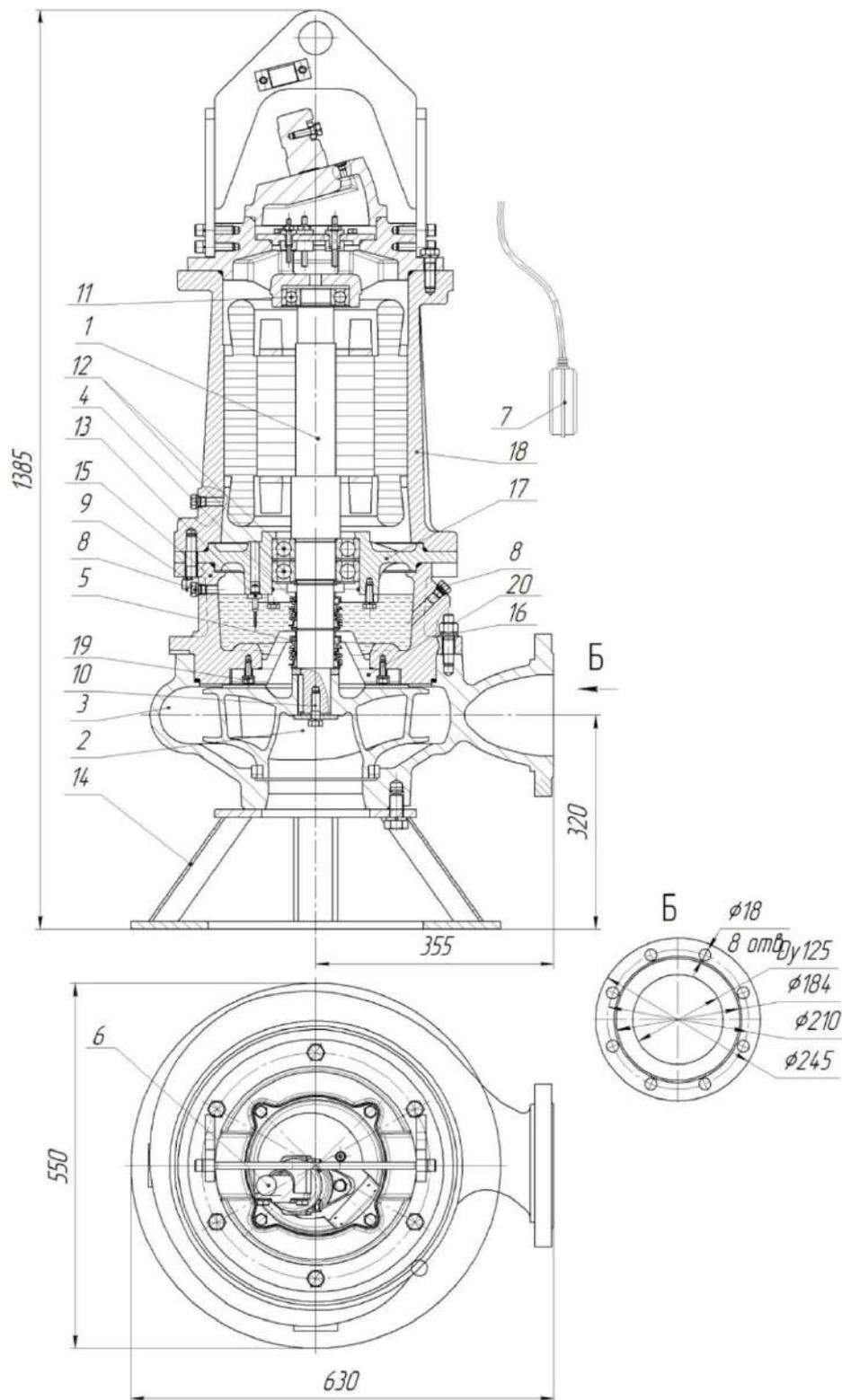
Рис.73 Общий вид, габаритные и присоединительные размеры электронасоса
