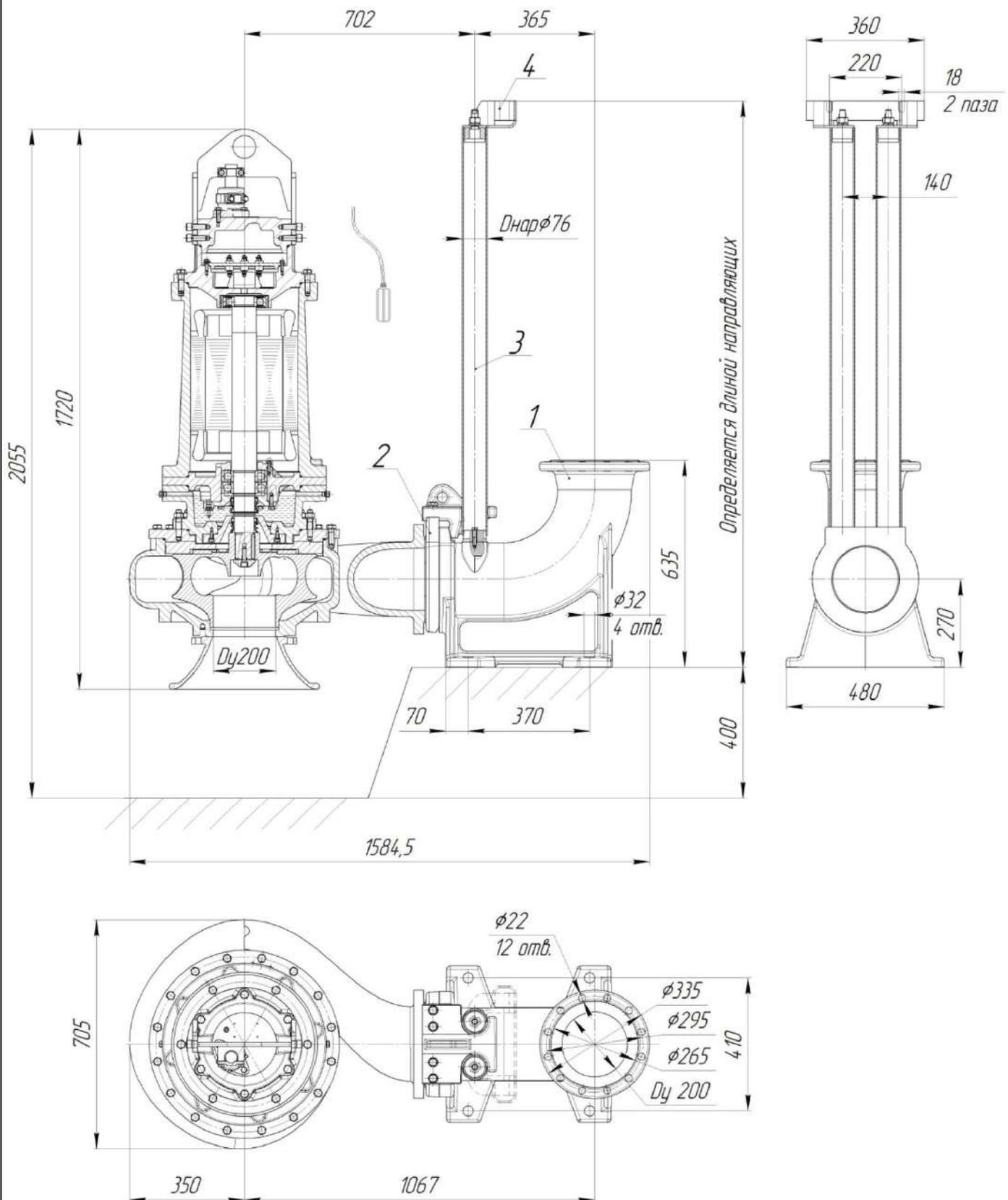
Рис.103 Общий вид и габаритные размеры электронасоса "Иртыш"
