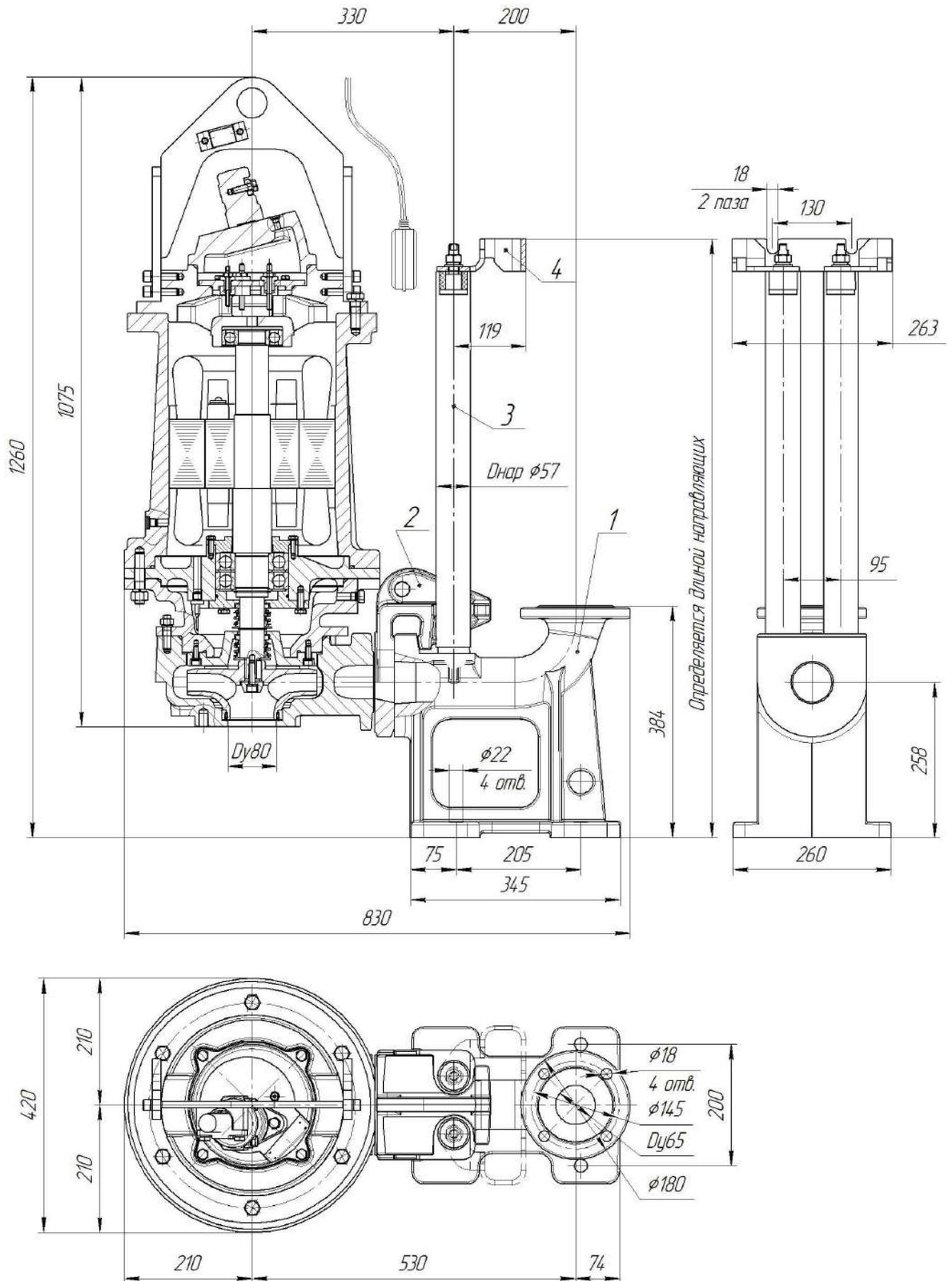
Рис.26 Общий вид и габаритные размеры электронасоса "Иртыш"
