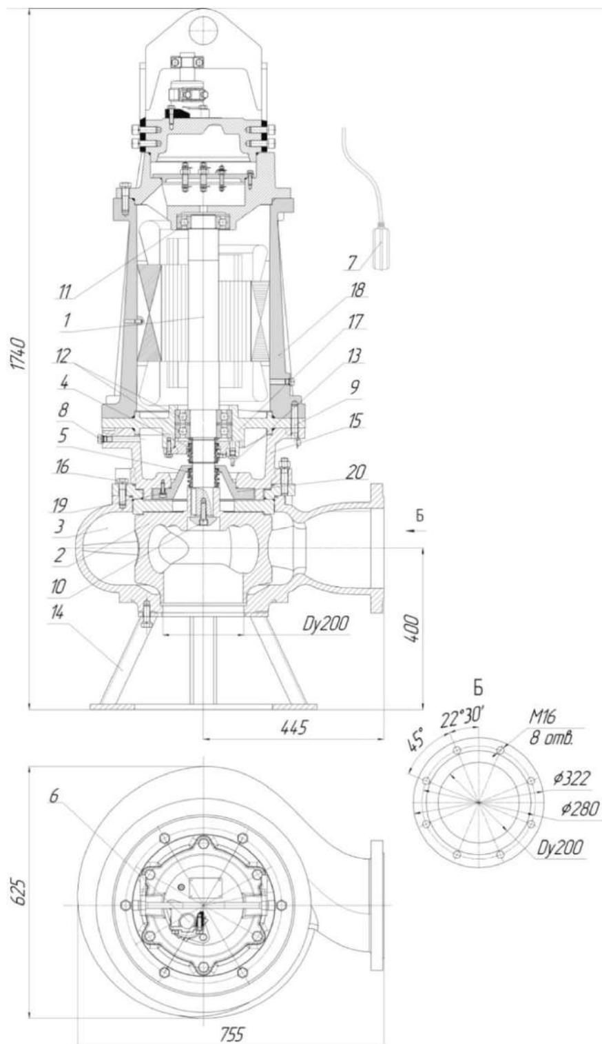
Рис.100 Общий вид, габаритные и присоединительные размеры электронасоса
