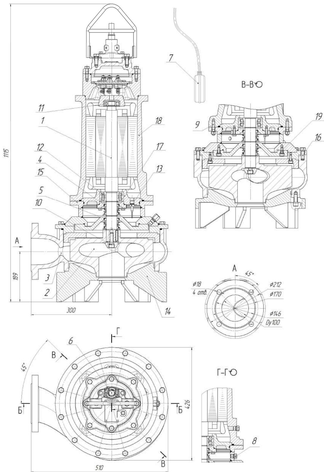
Рис.68 Общий вид, габаритные и присоединительные размеры электронасоса
