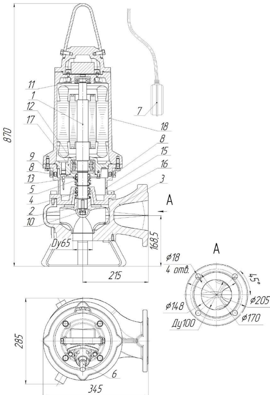
Рис.59 Общий вид, габаритные и присоединительные размеры электронасоса
