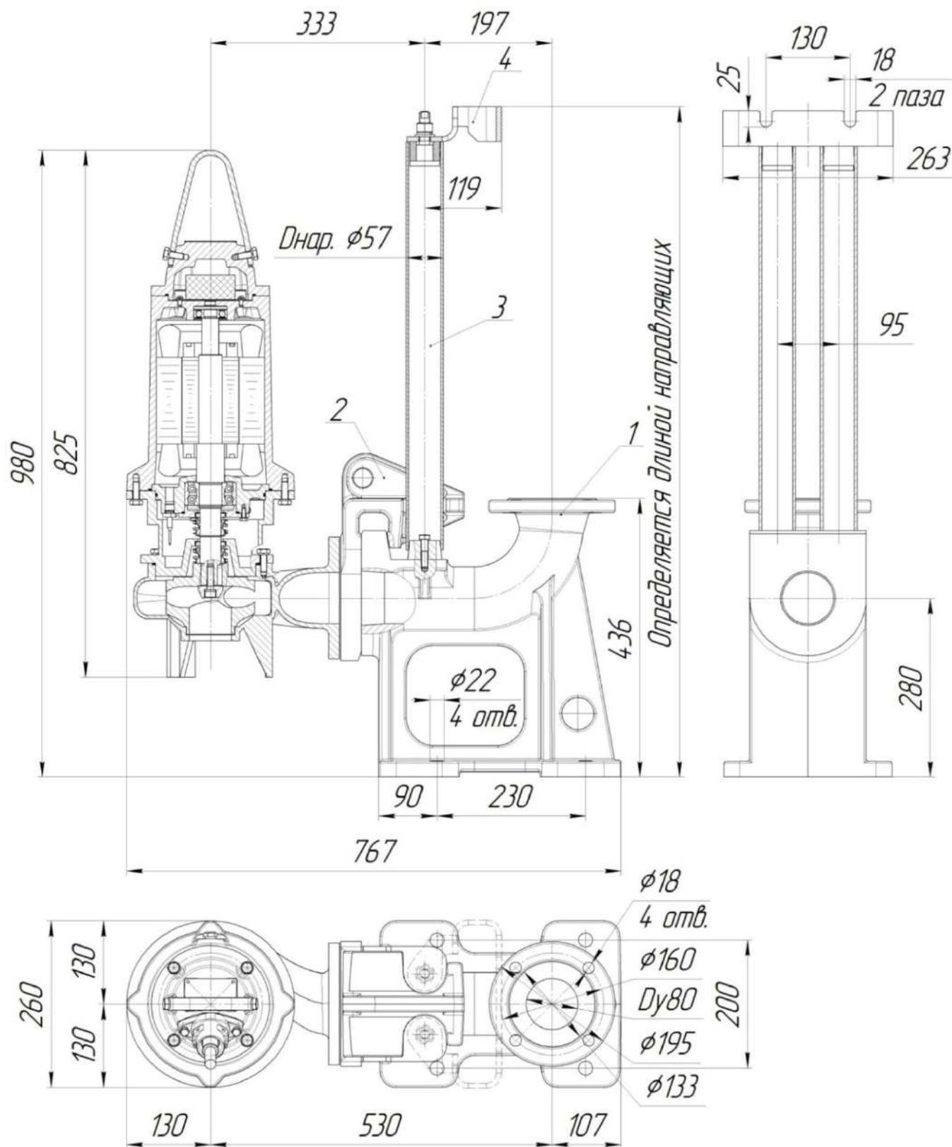
Рис.48 Общий вид и габаритные размеры электронасоса "Иртыш"
