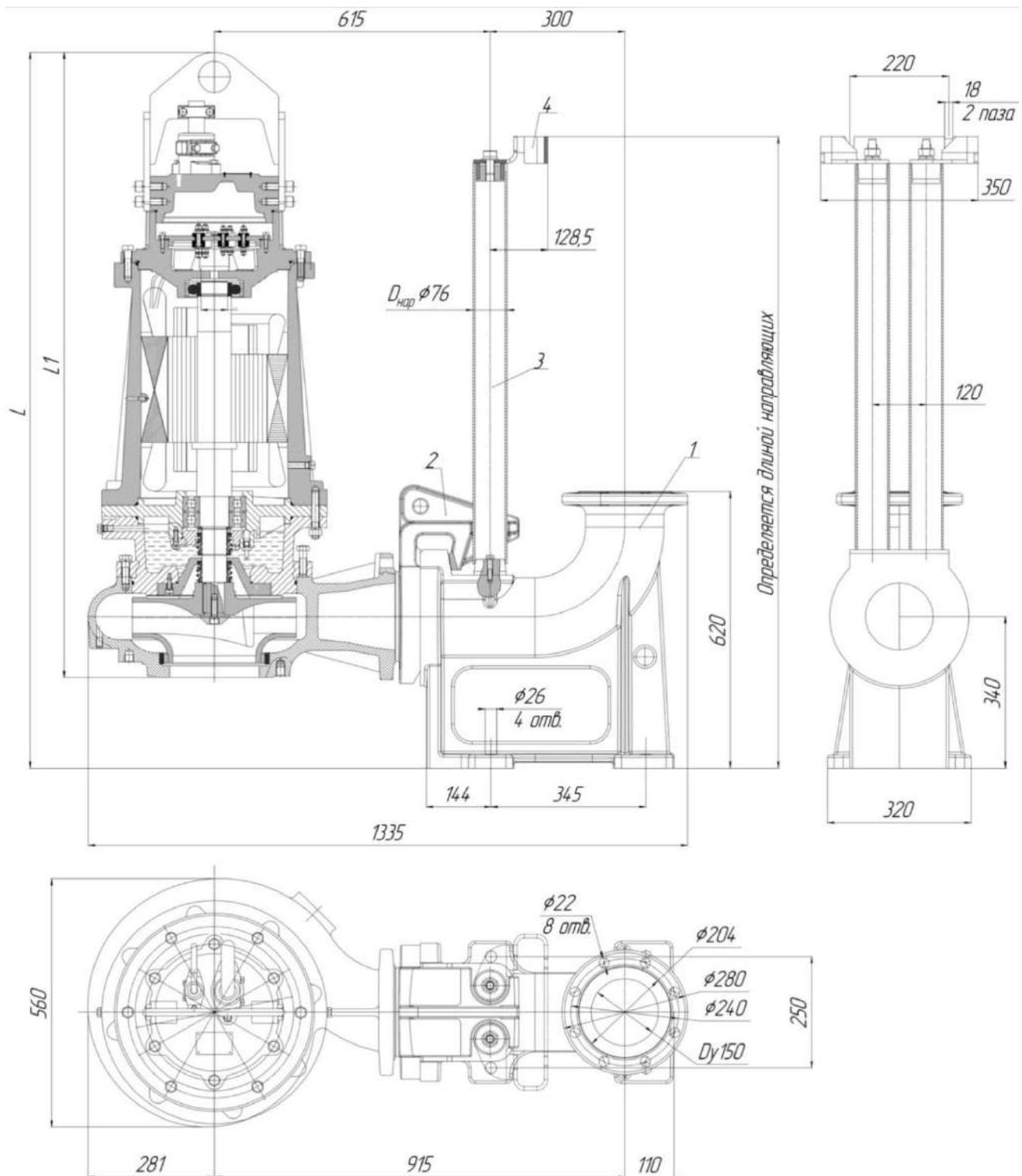
Рис.89 Общий вид и габаритные размеры электронасоса «Иртыш» ПФ2 150/315 – 37/4-106, ПФ2 150/315 – 45/4-106, ПФ2 150/315 – 55/4-106 с опускающим устройством.
