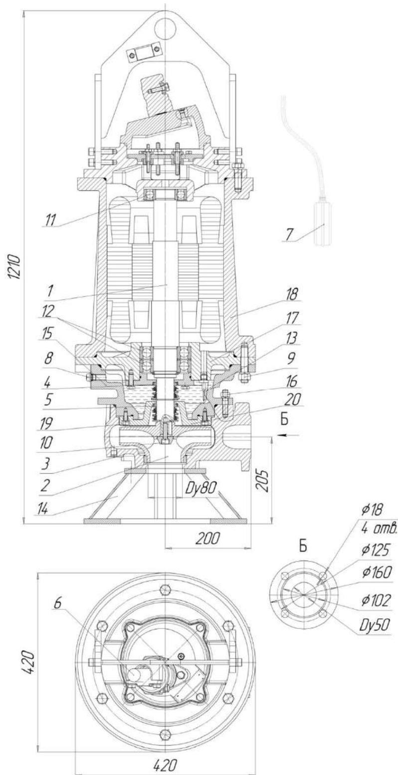
Рис.25 Общий вид, габаритные и присоединительные размеры электронасоса
