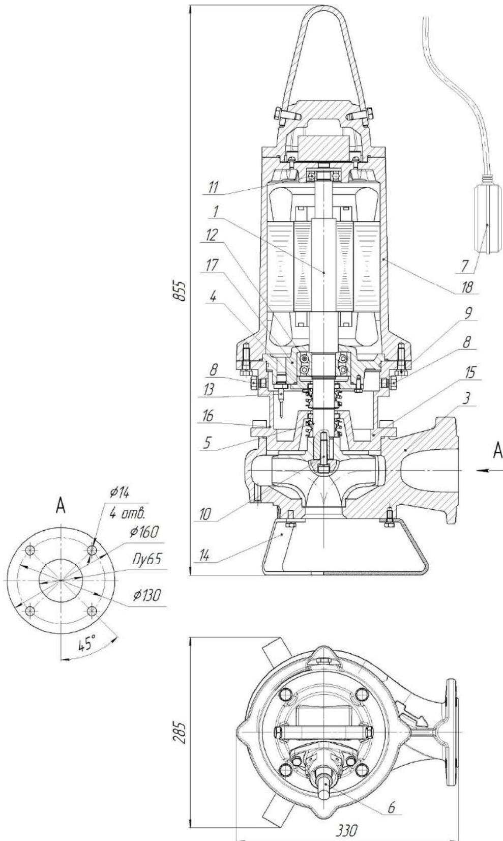
Рис.31 Общий вид, габаритные и присоединительные размеры электронасоса
