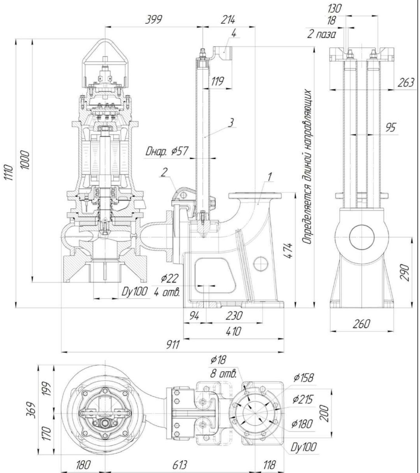
Рис.64 Общий вид и габаритные размеры электронасоса "Иртыш"
