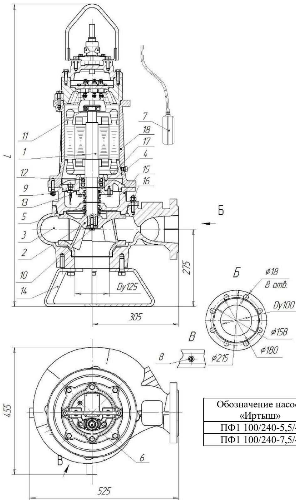
Рис.57 Общий вид, габаритные и присоединительные размеры электронасоса «Иртыш» ПФ1 100/240 –5,5/4, ПФ1 100/240-7,5/4.
