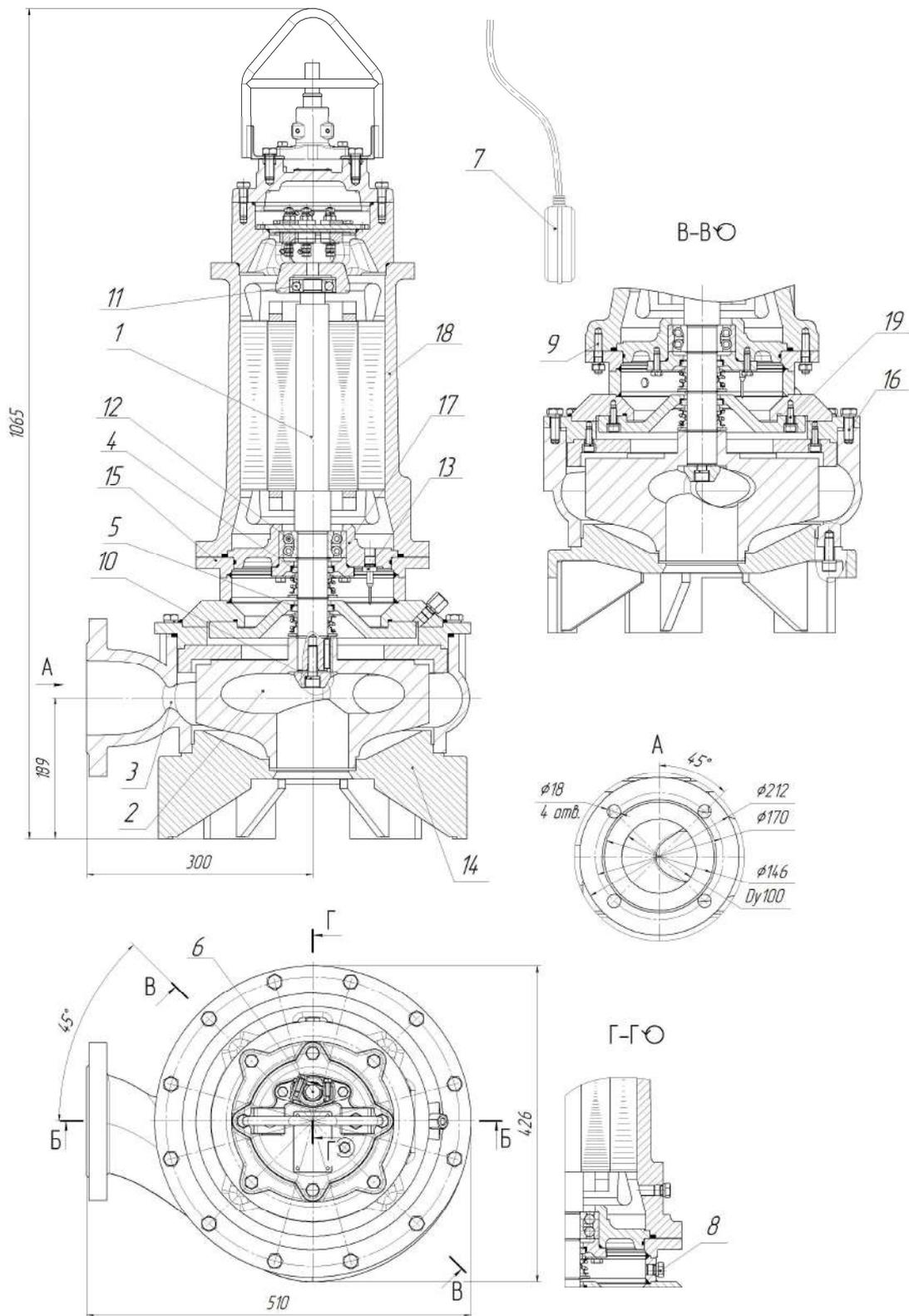
Рис.67 Общий вид, габаритные и присоединительные размеры электронасоса
