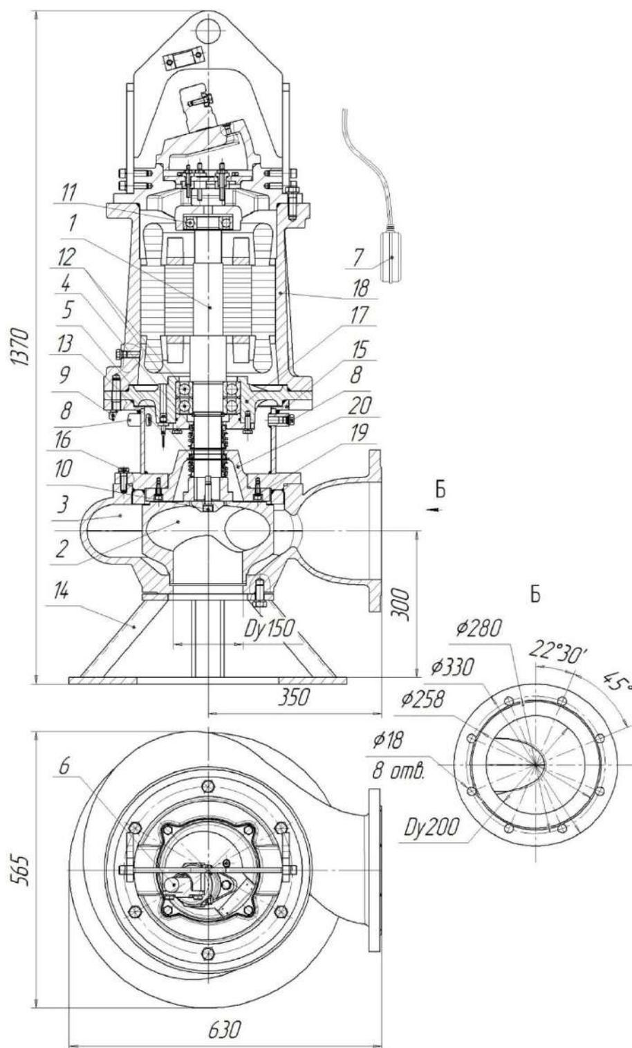
Рис.96 Общий вид, габаритные и присоединительные размеры электронасоса
