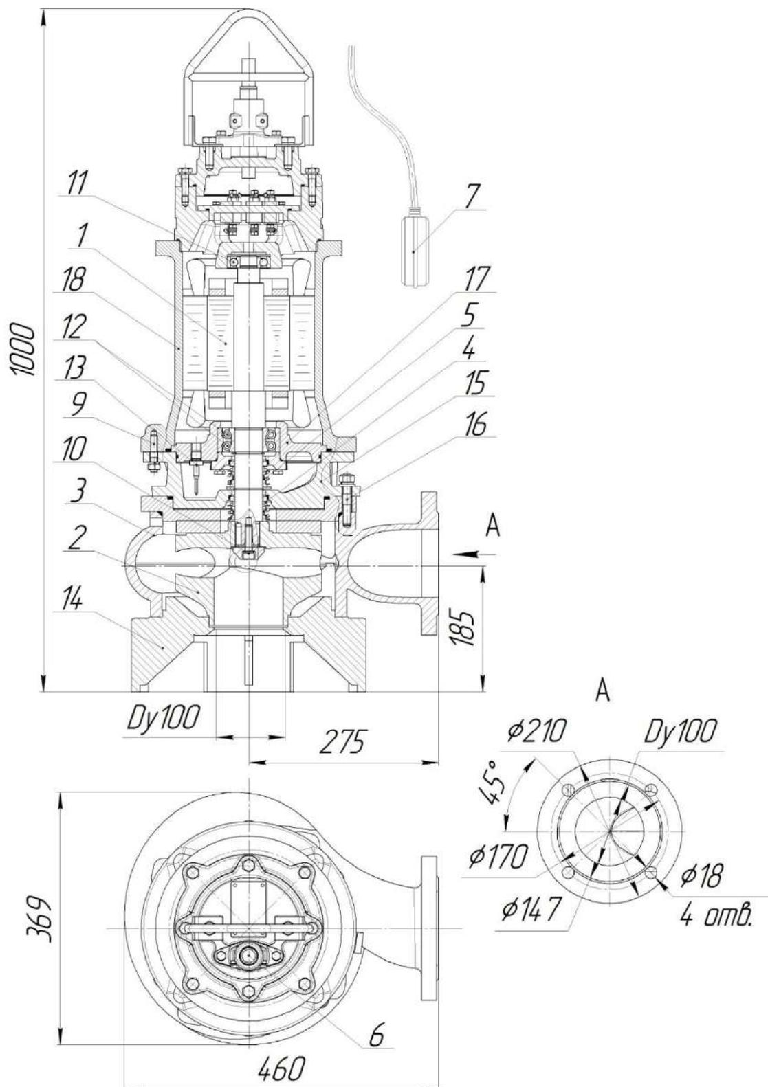
Рис.63 Общий вид, габаритные и присоединительные размеры электронасоса
