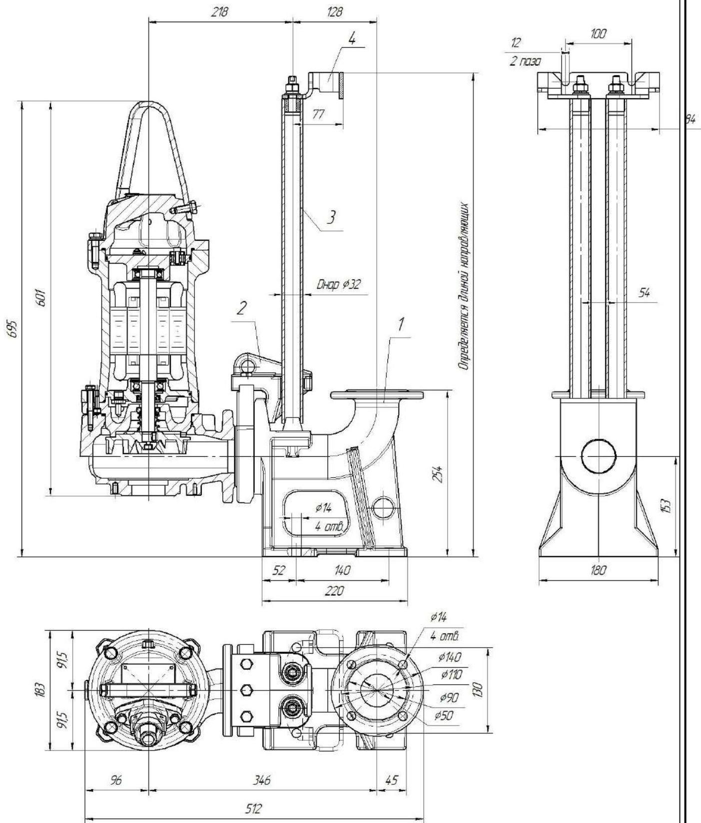
Рис.16 Общий вид и габаритные размеры электронасоса
