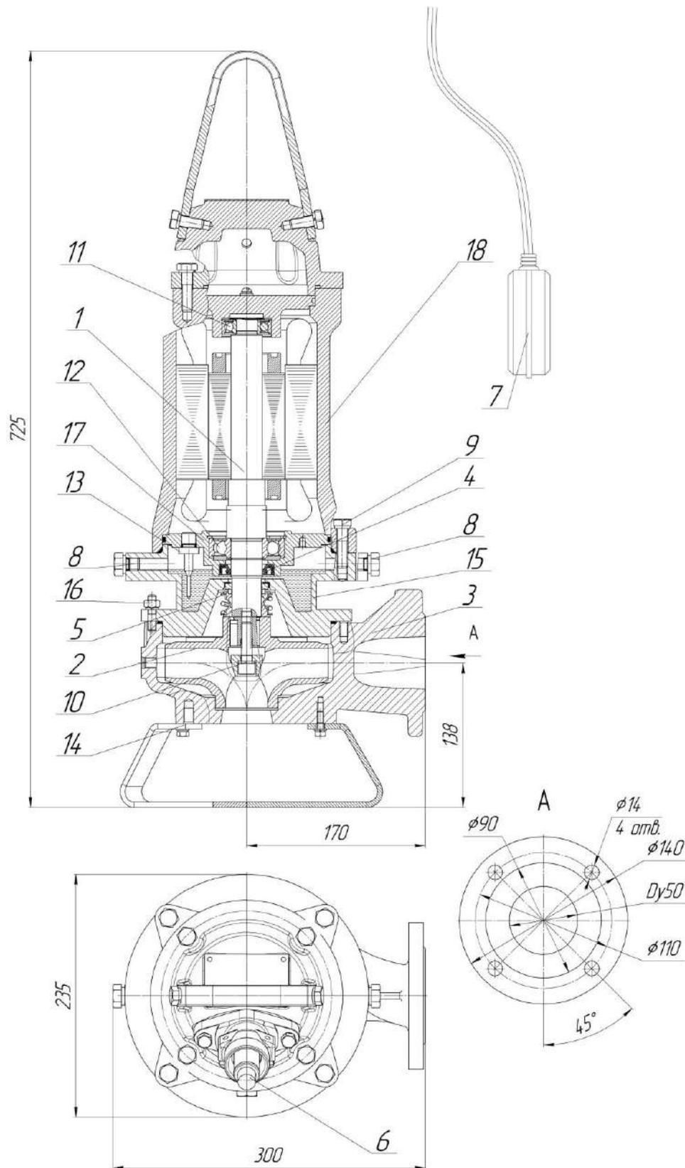
Рис.19 Общий вид, габаритные и присоединительные размеры электронасоса “Иртыш”
