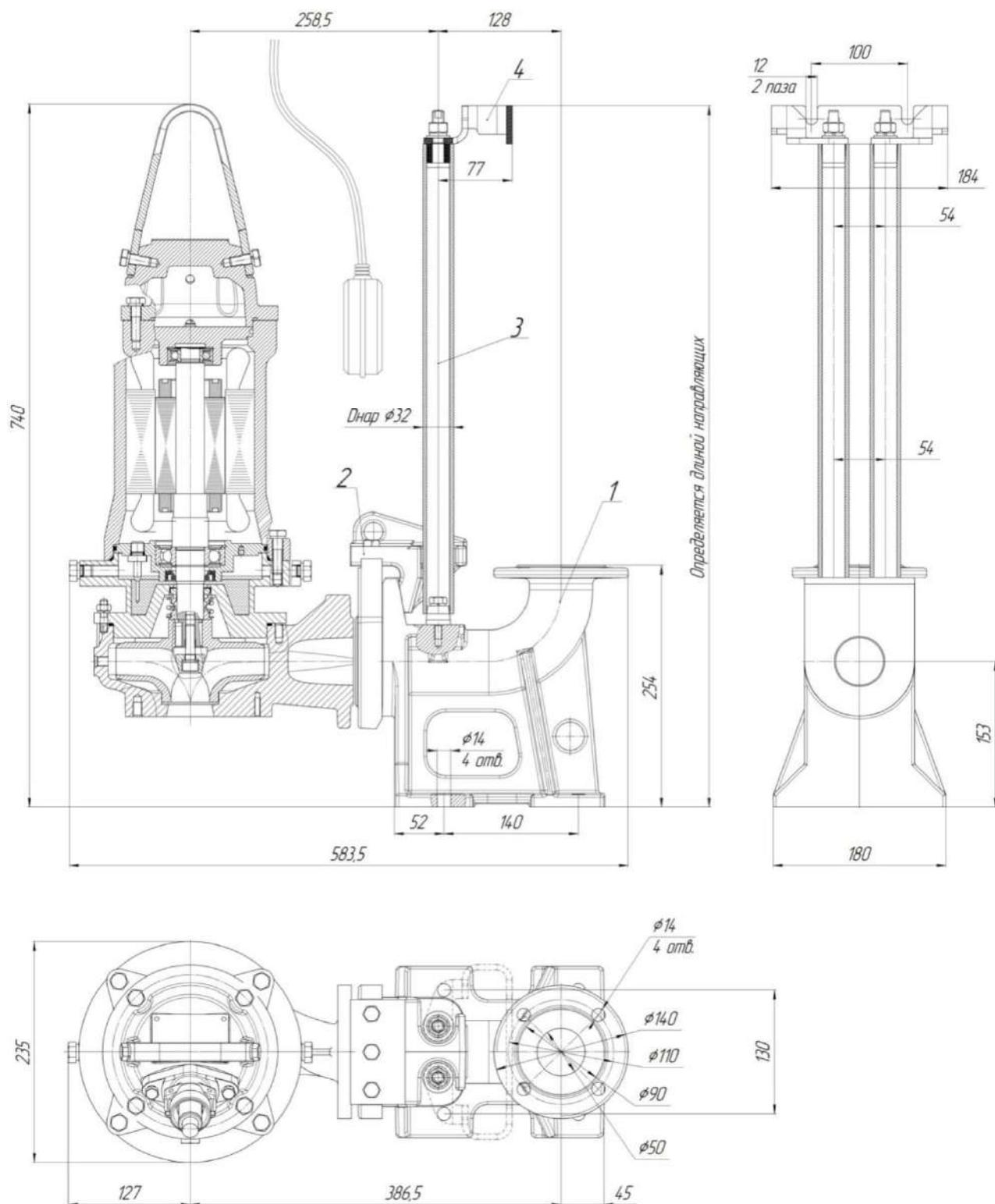
Рис.20 Общий вид и габаритные размеры электронасоса "Иртыш" ПФ2 50/150 – 3/2-106 с опускным устройством.
