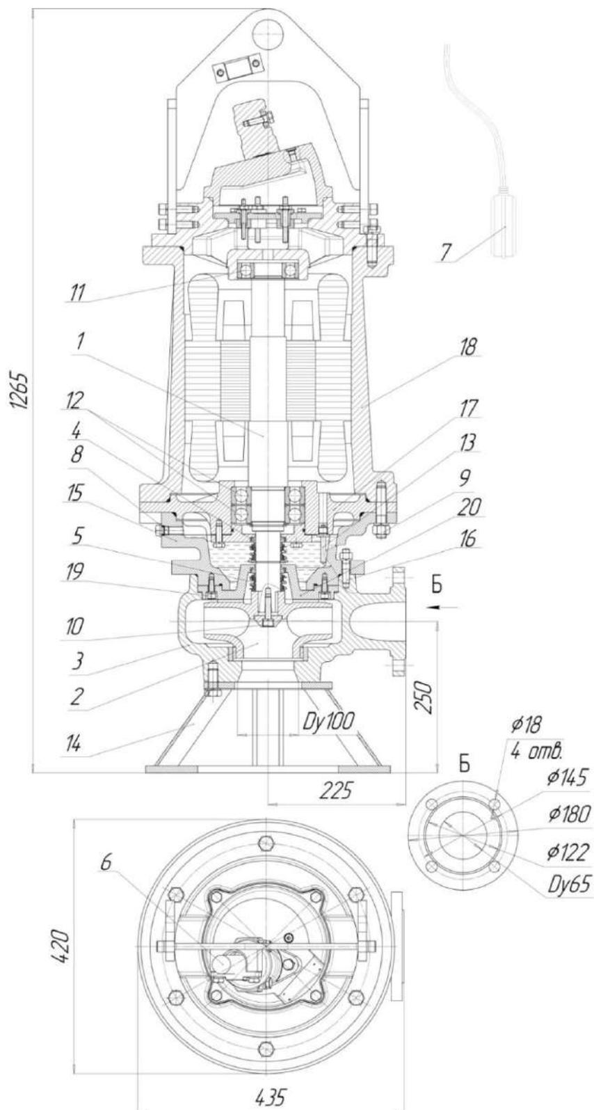
Рис.43 Общий вид, габаритные и присоединительные размеры электронасоса
