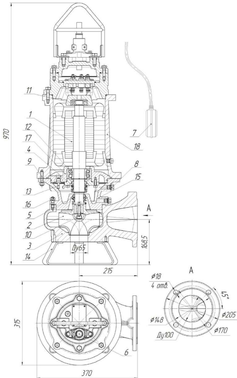
Рис.61 Общий вид, габаритные и присоединительные размеры электронасоса
