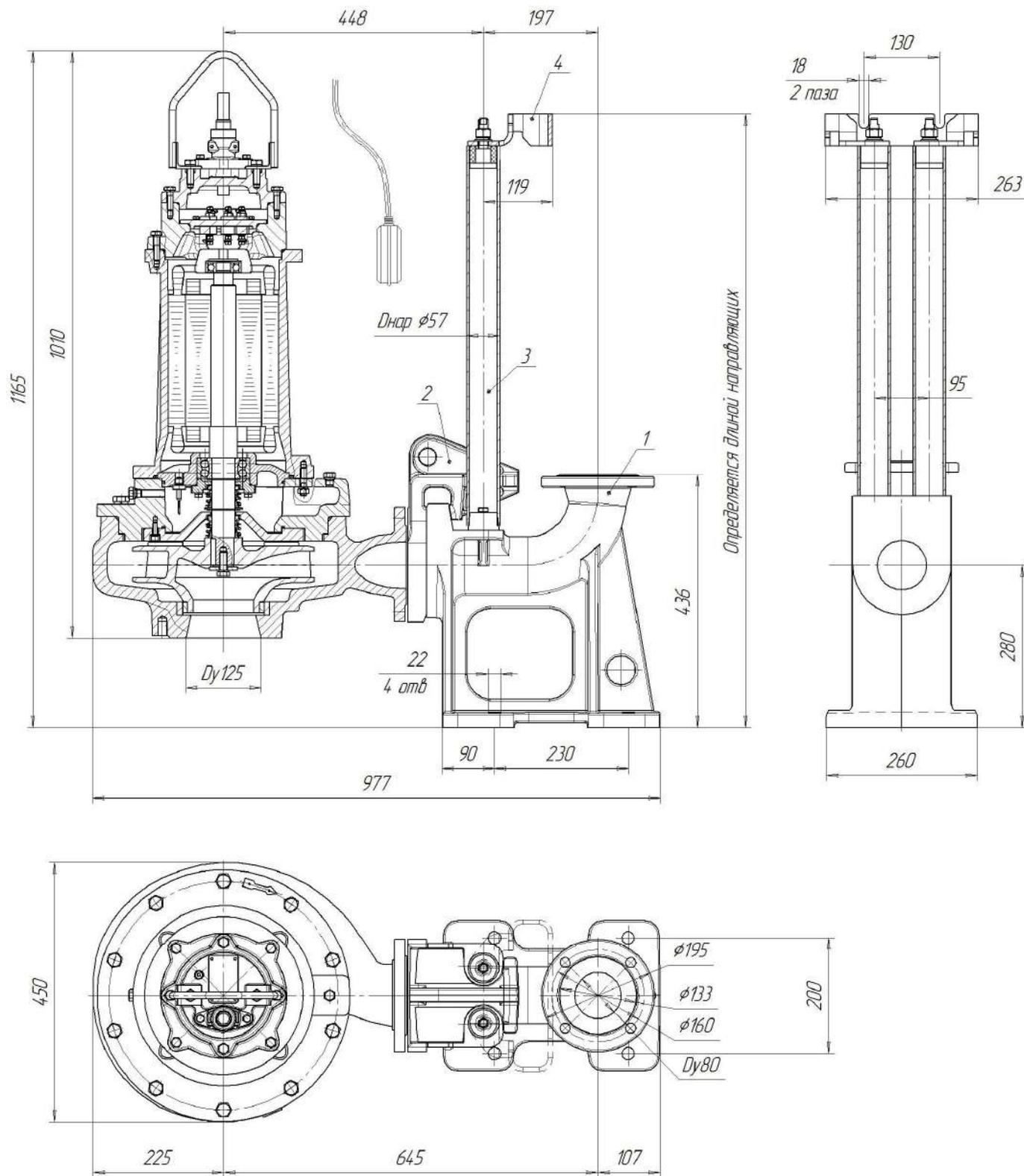
Рис.52 Общий вид и габаритные размеры электронасоса "Иртыш"
