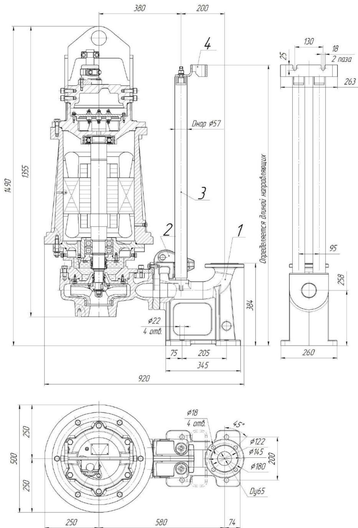
Рис.42 Общий вид и габаритные размеры электронасоса “Иртыш”
