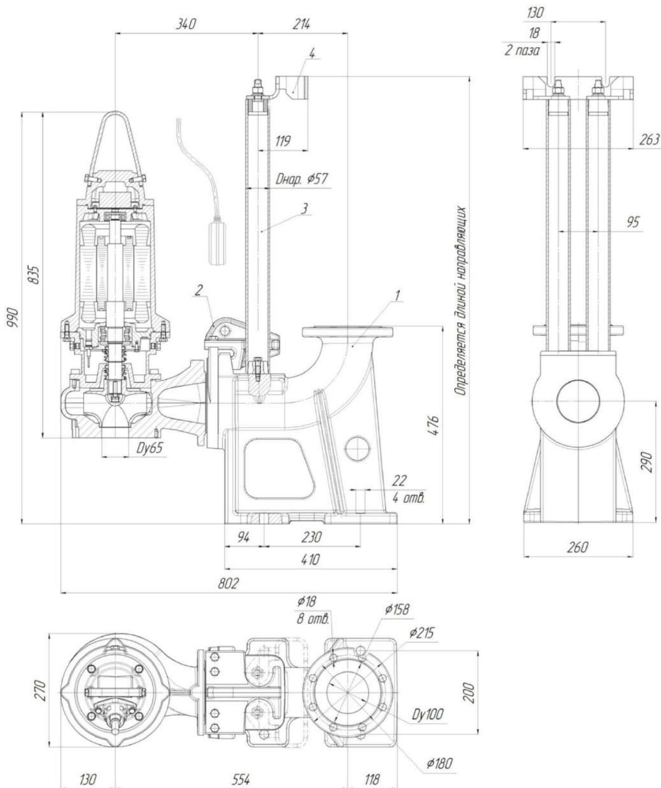
Рис.60 Общий вид и габаритные размеры электронасоса “Иртыш”
