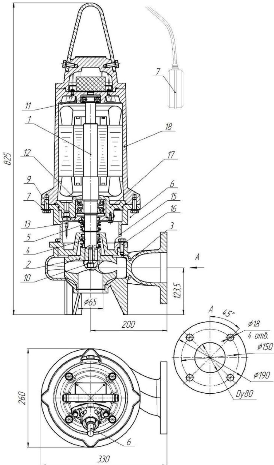
Рис.47 Общий вид, габаритные и присоединительные размеры электронасоса
