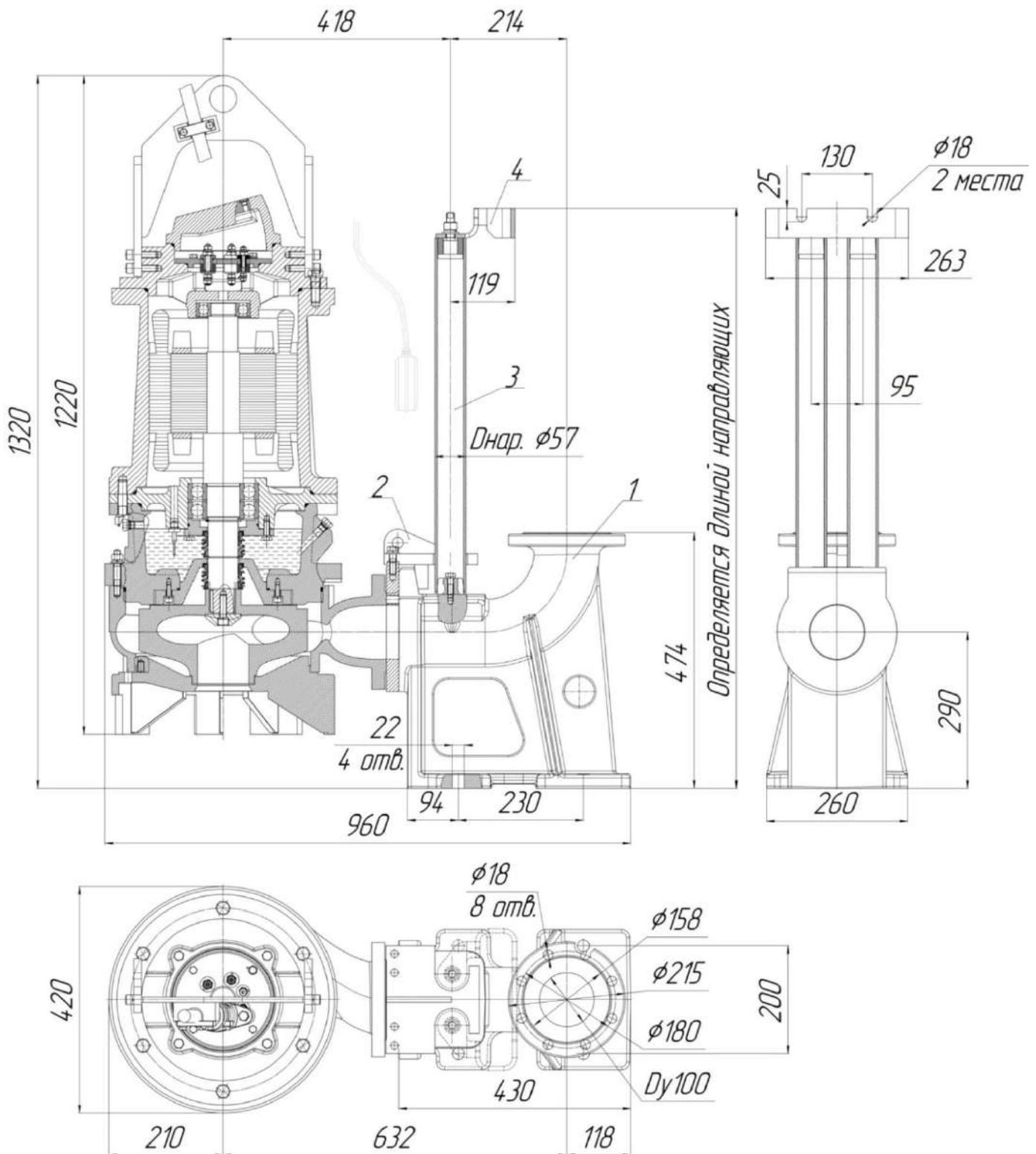
Рис.71 Общий вид и габаритные размеры электронасоса “Иртыш”
