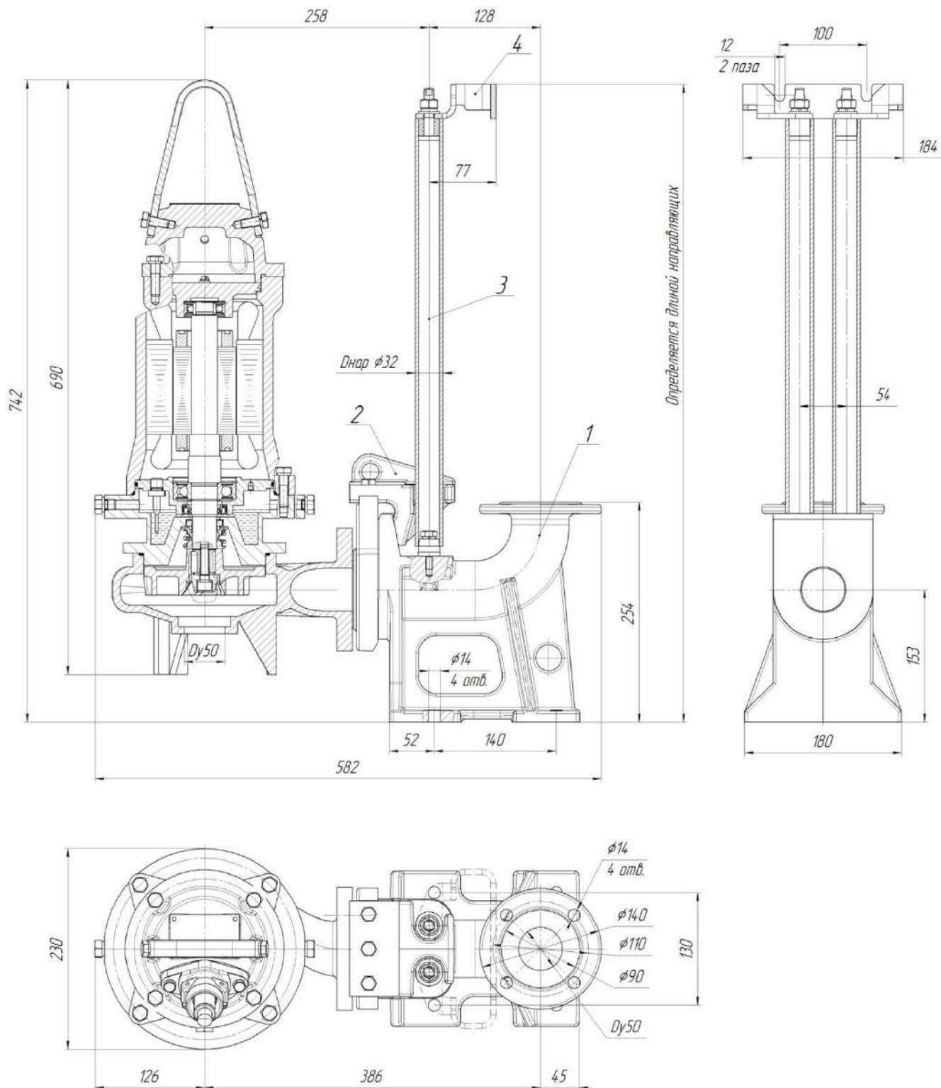
Рис.18 Общий вид и габаритные размеры электронасоса "Иртыш" ПФ2 50/140 – 3/2-106 с опускным устройством.
