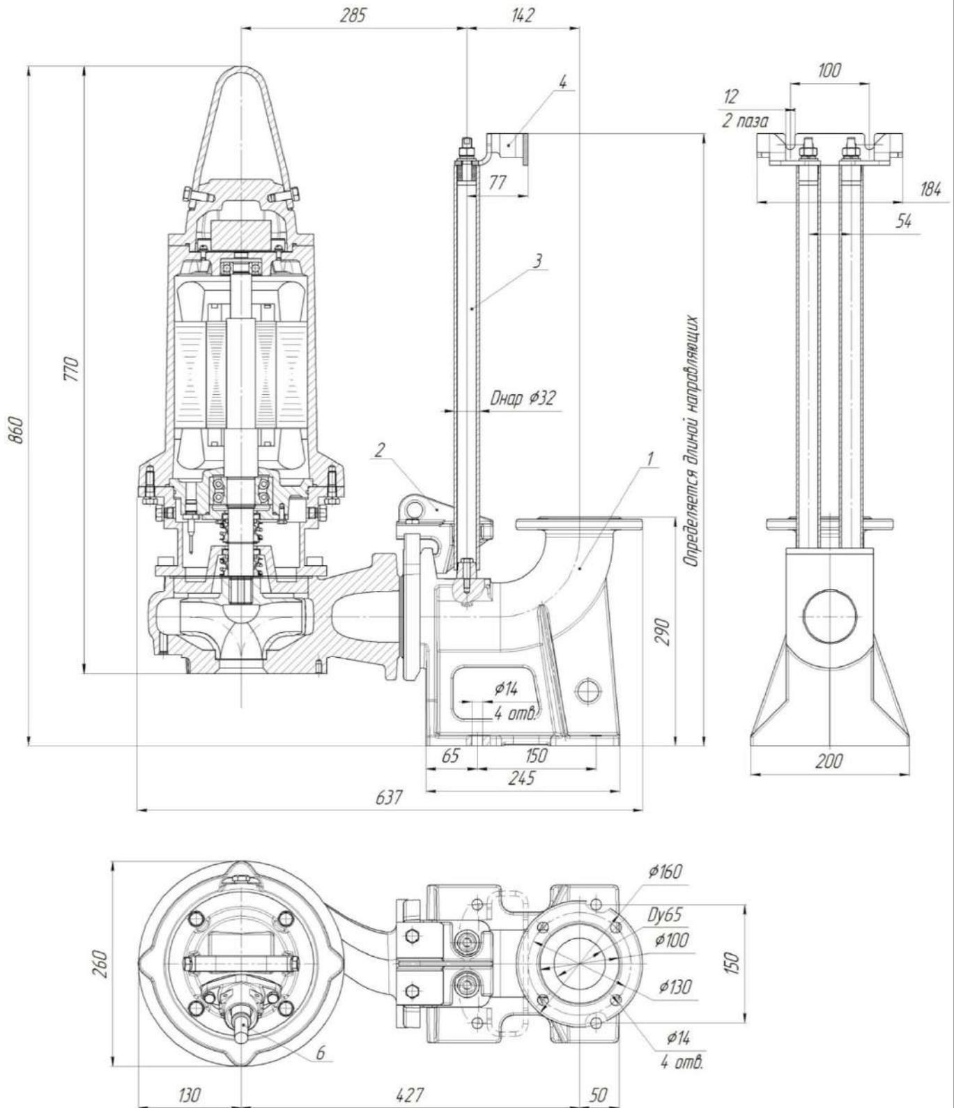
Рис.32 Общий вид и габаритные размеры электронасоса
