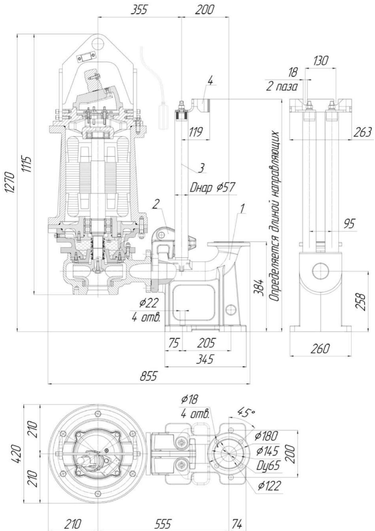
Рис.44 Общий вид и габаритные размеры электронасоса "Иртыш"
