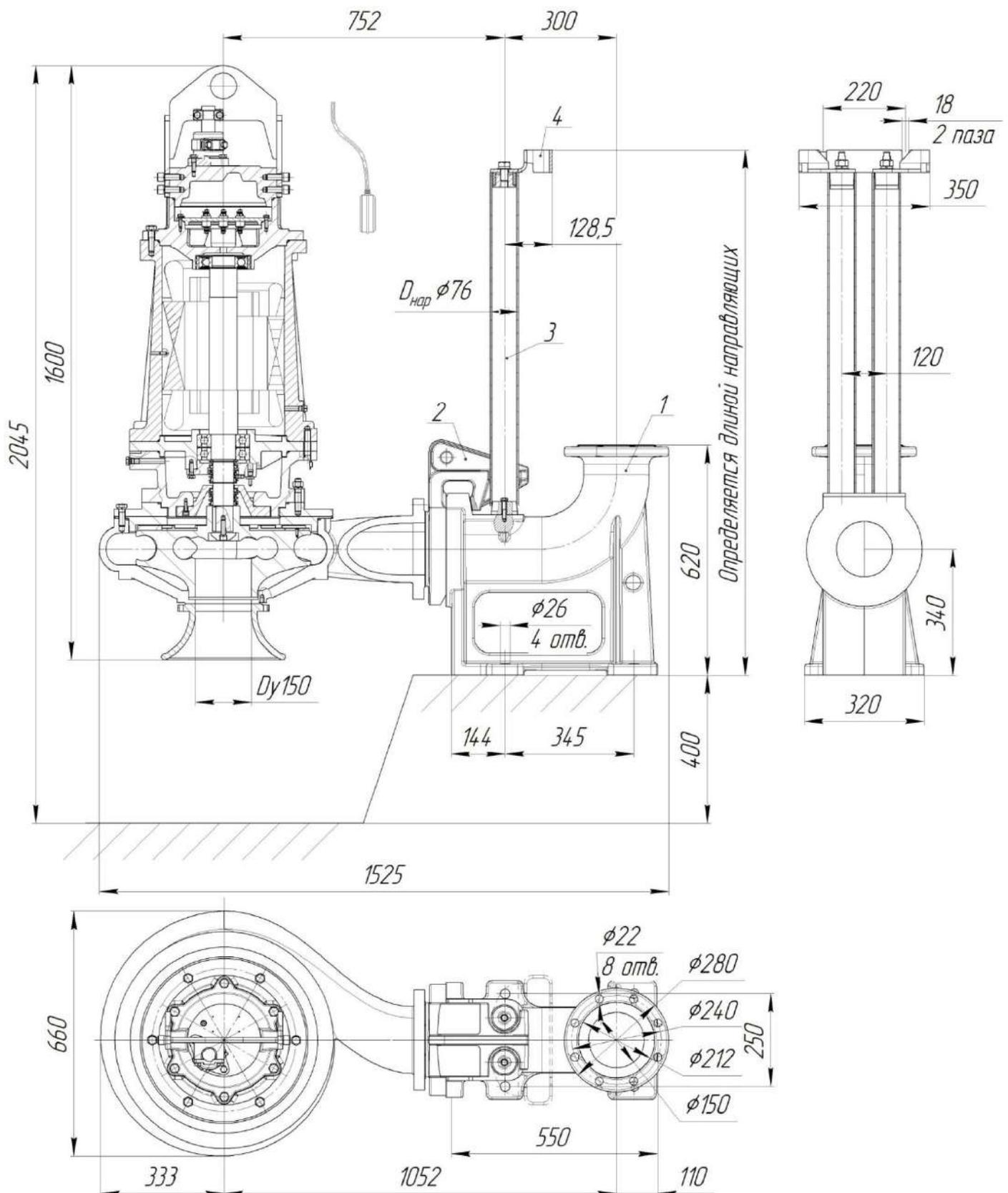
Рис.93 Общий вид и габаритные размеры электронасоса “Иртыш”
