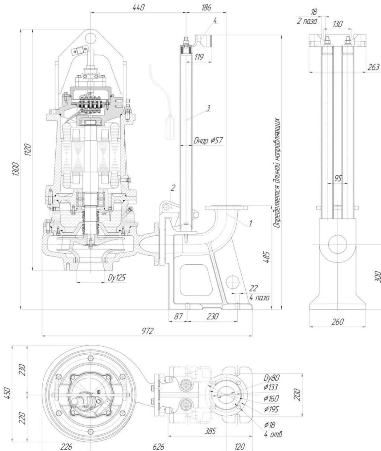
Рис.54 Общий вид и габаритные размеры электронасоса "Иртыш"
