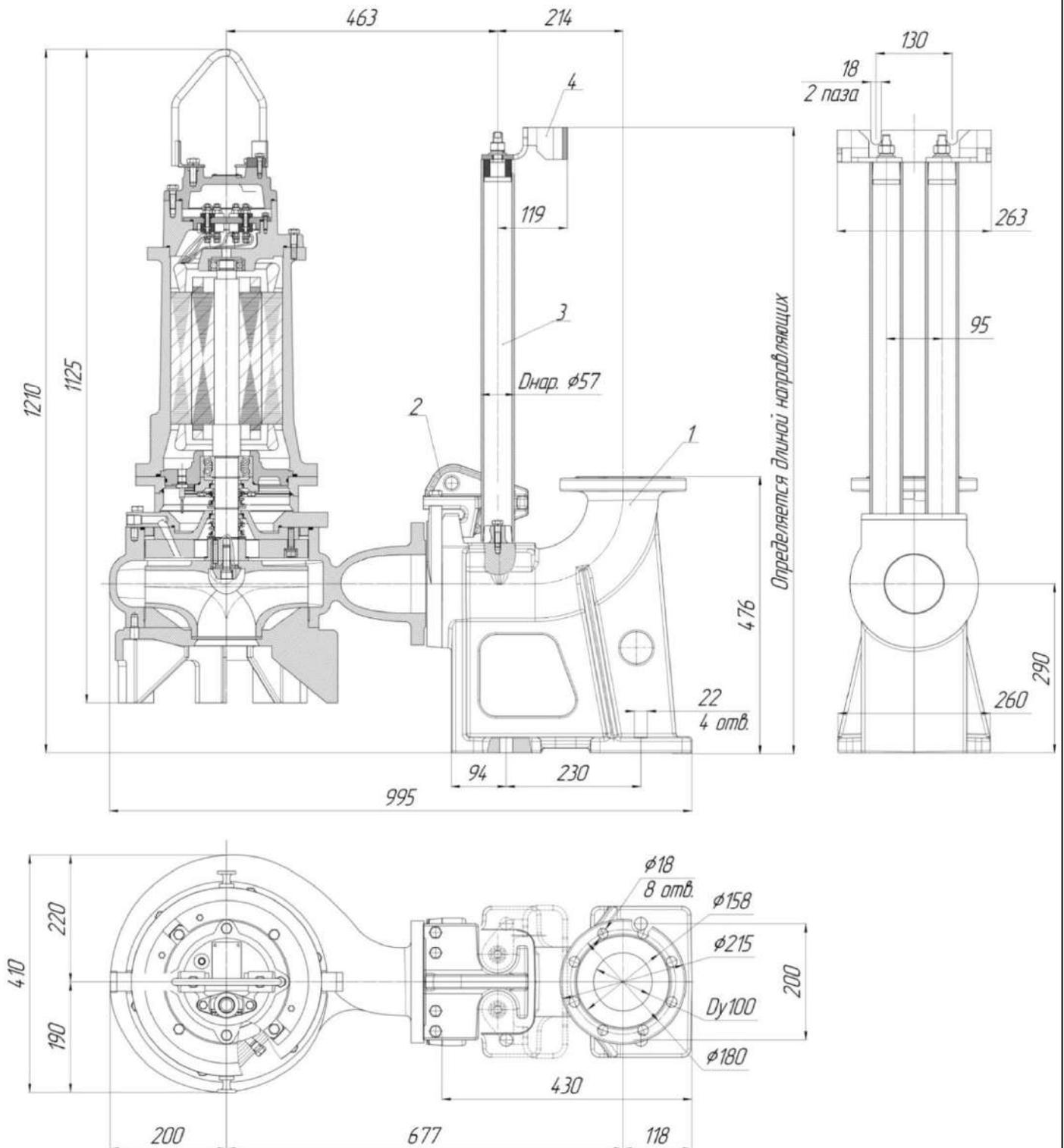
Рис.66 Общий вид и габаритные размеры электронасоса “Иртыш”
