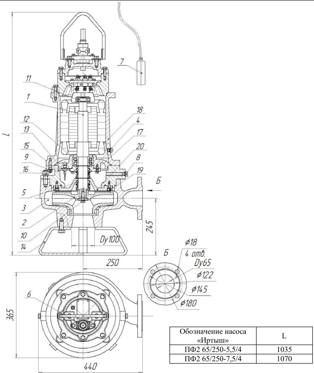
Рис.39 Общий вид, габаритные и присоединительные размеры электронасоса «Иртыш» ПФ2 65/250 –5,5/4, ПФ2 65/250 –7,5/4.
