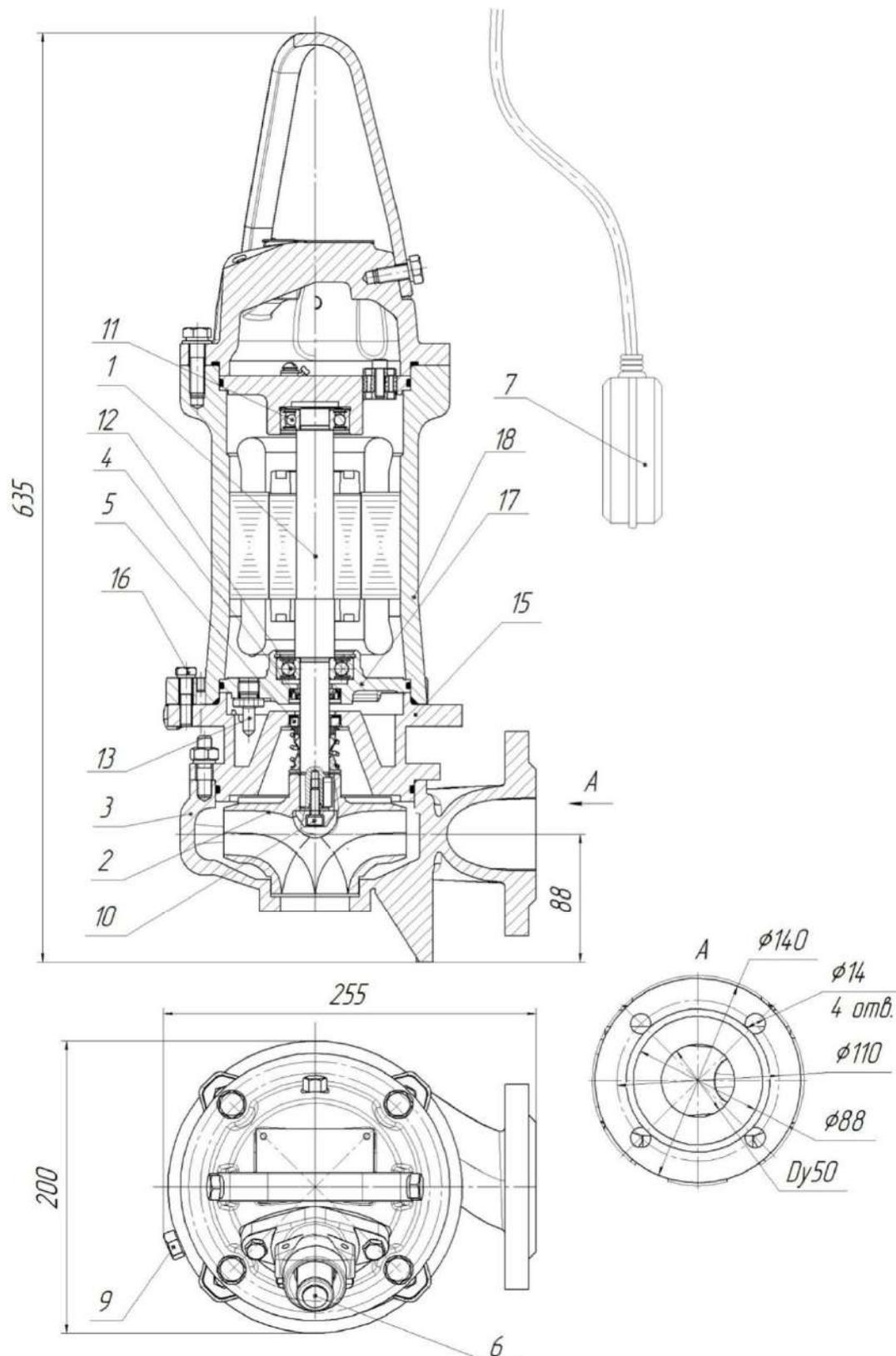
Рис.13 Общий вид, габаритные и присоединительные размеры электронасоса
