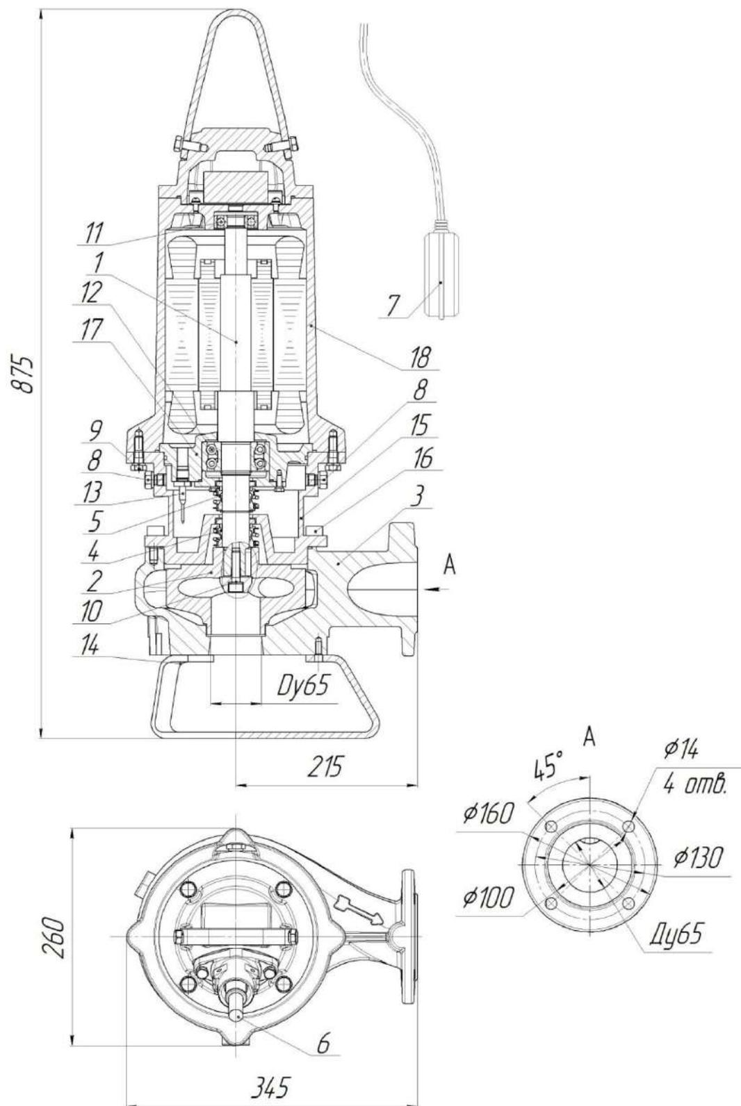
Рис.35 Общий вид, габаритные и присоединительные размеры электронасоса
