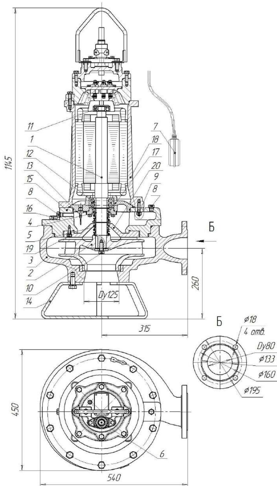
Рис.51 Общий вид, габаритные и присоединительные размеры электронасоса
