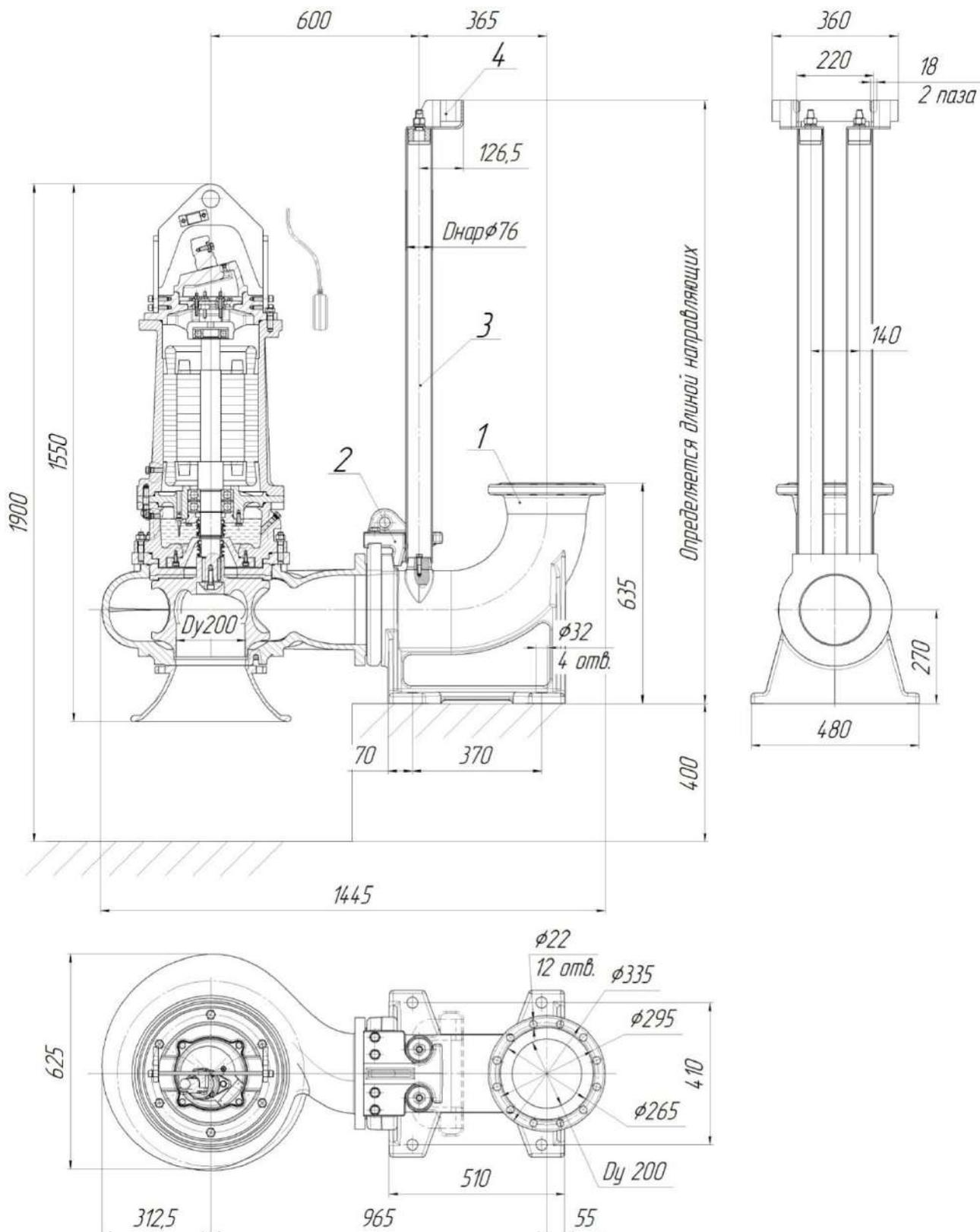
Рис.99 Общий вид и габаритные размеры электронасоса “Иртыш”
