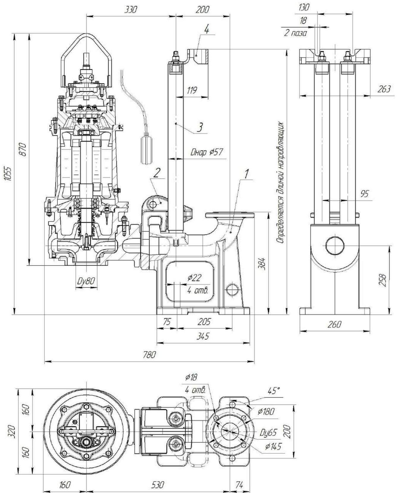
Рис.22 Общий вид и габаритные размеры электронасоса "Иртыш" ПФ2 50/200 – 7,5/2-106 с опускным устройством.
