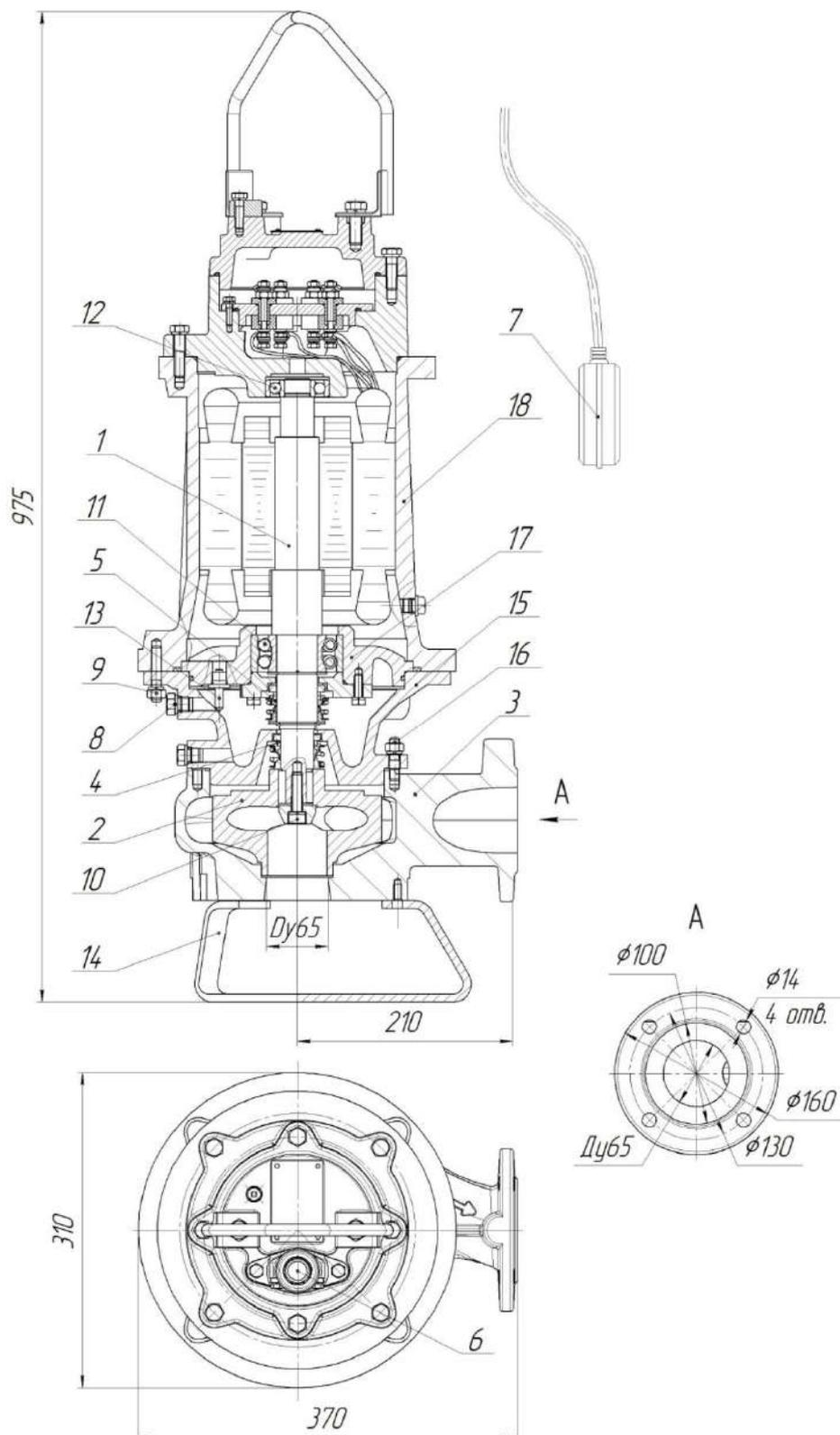
Рис.37 Общий вид, габаритные и присоединительные размеры электронасоса
