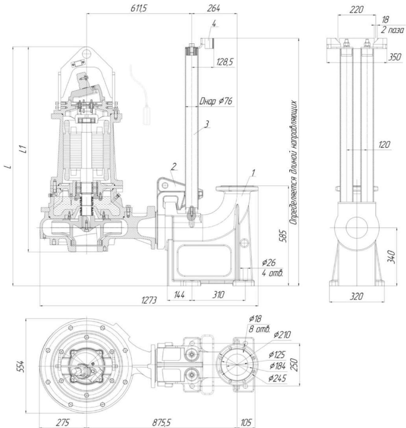
Рис.79 Общий вид и габаритные размеры
