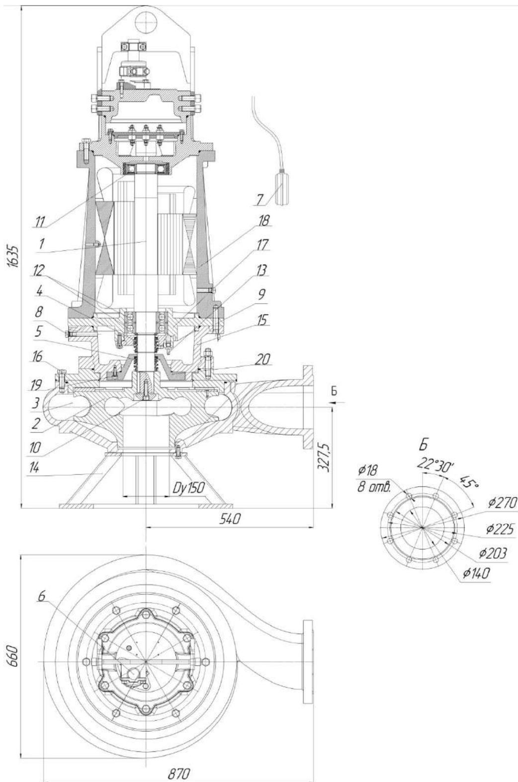
Рис.92 Общий вид, габаритные и присоединительные размеры электронасоса
