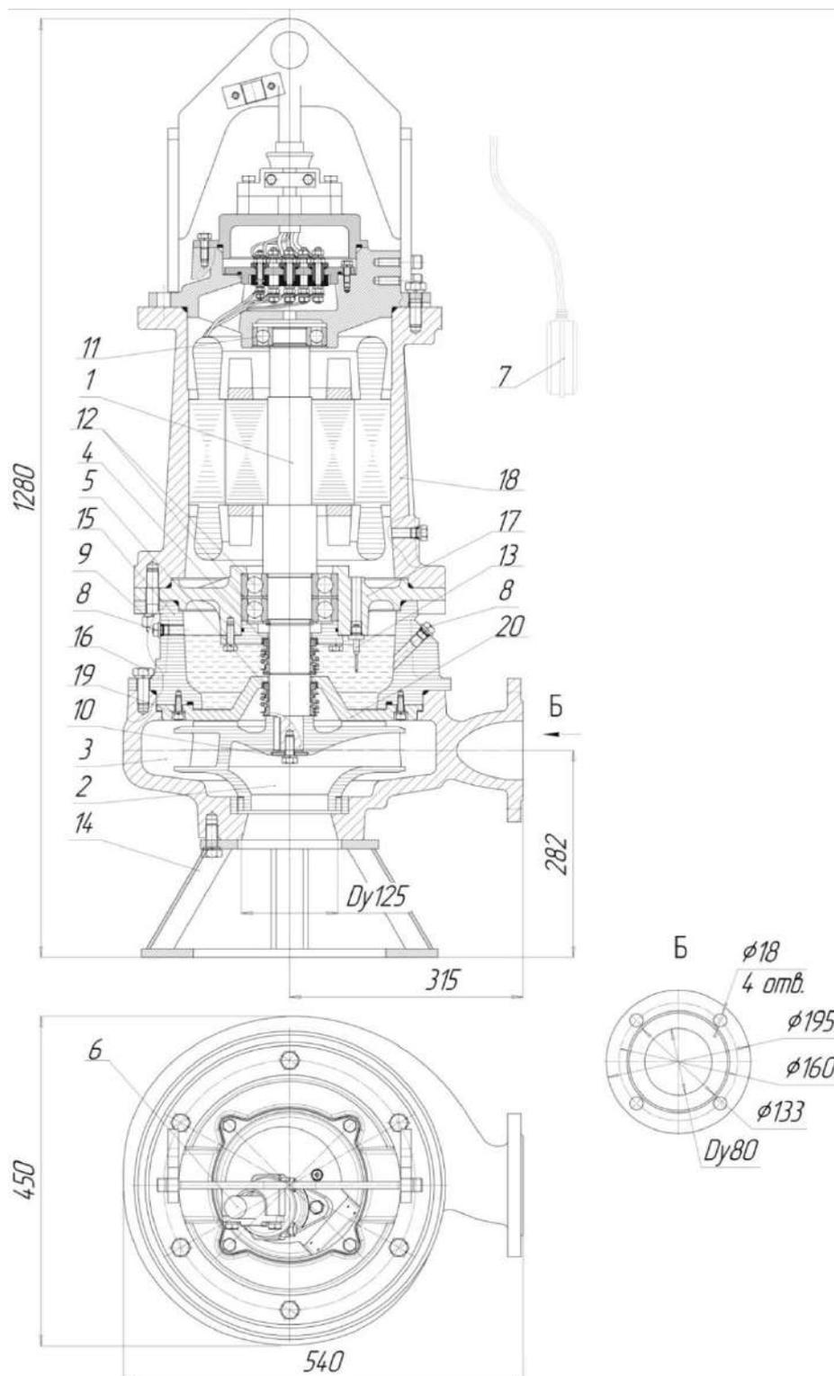
Рис.53 Общий вид, габаритные и присоединительные размеры электронасоса
