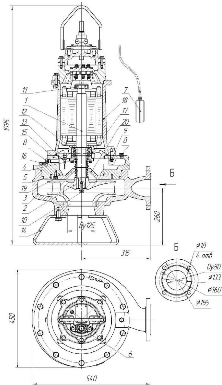
Рис.49 Общий вид, габаритные и присоединительные размеры электронасоса
