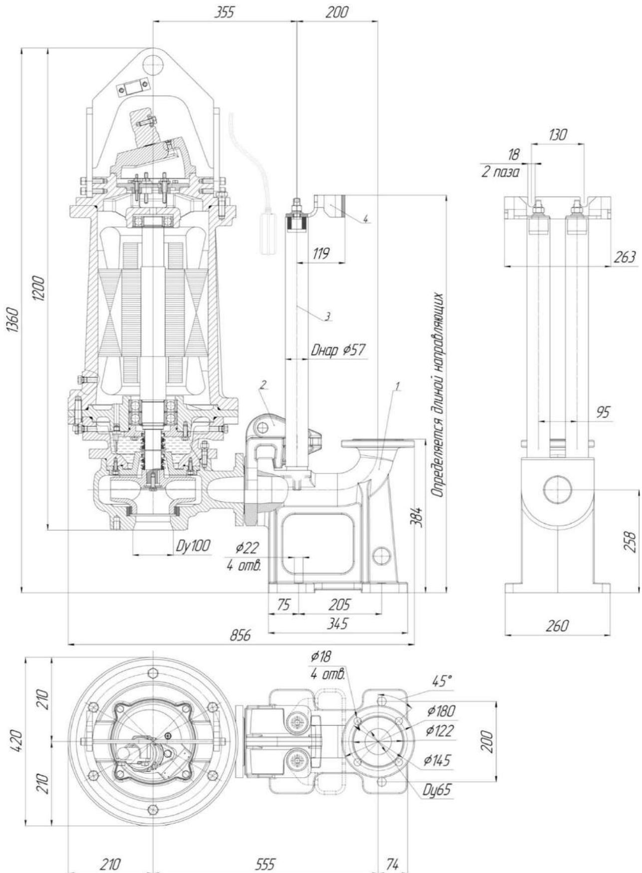
Рис.46 Общий вид и габаритные размеры электронасоса "Иртыш"
