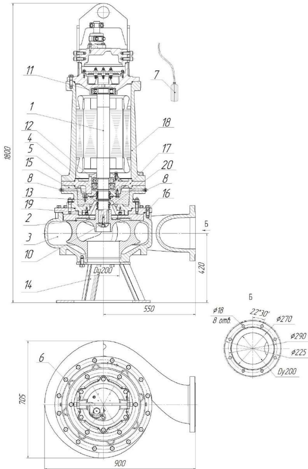
Рис.102 Общий вид, габаритные и присоединительные размеры электронасоса
