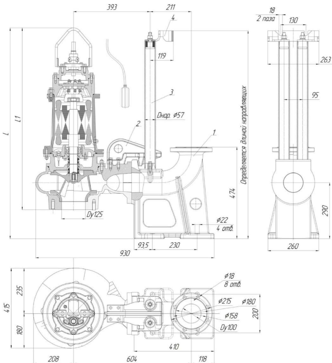
Рис.58 Общий вид и габаритные размеры электронасоса «Иртыш» ПФ1 100/240 – 5,5/4-106, ПФ1 100/240 – 7,5/4-106 с опускным устройством.
