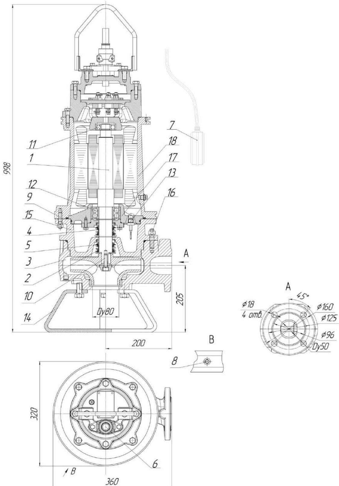
Рис.21 Общий вид, габаритные и присоединительные размеры электронасоса
