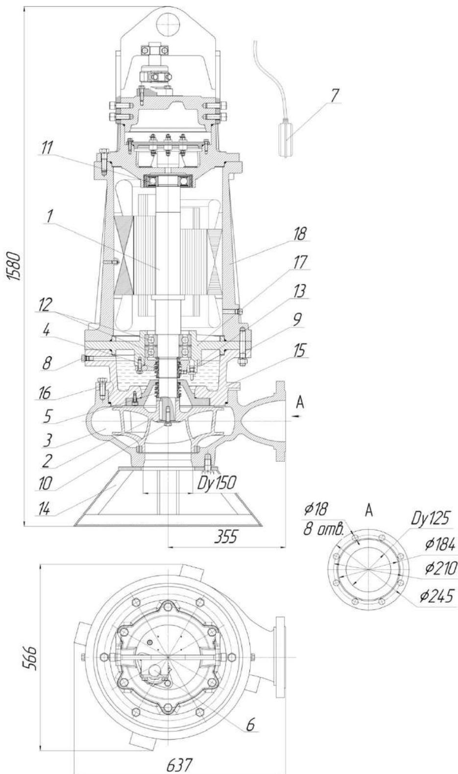
Рис.76 Общий вид, габаритные и присоединительные размеры электронасоса “Иртыш” ПФ2 125/315 – 37/4.
