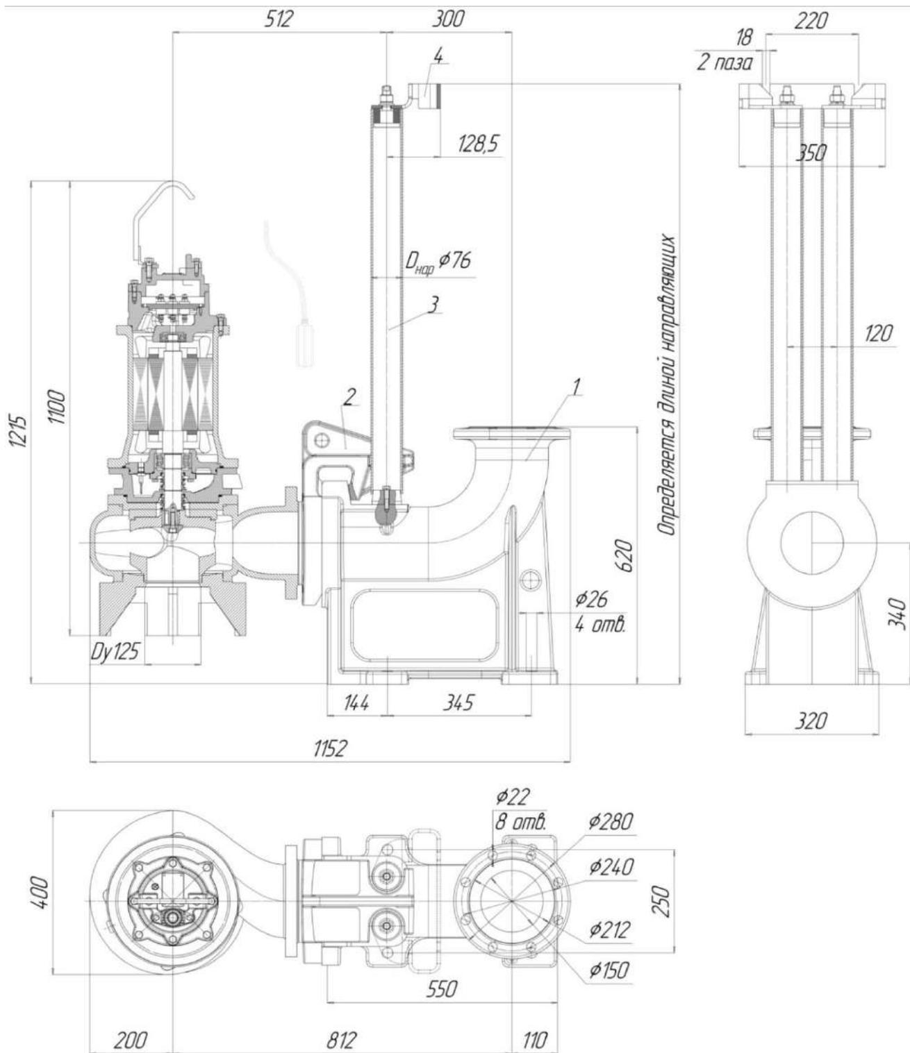
Рис.83 Общий вид и габаритные размеры электронасоса "Иртыш"
