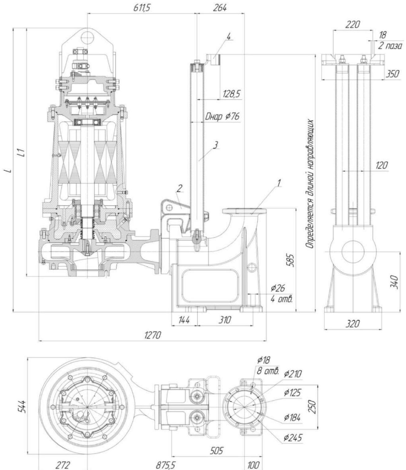
Рис.81 Общий вид и габаритные размеры
