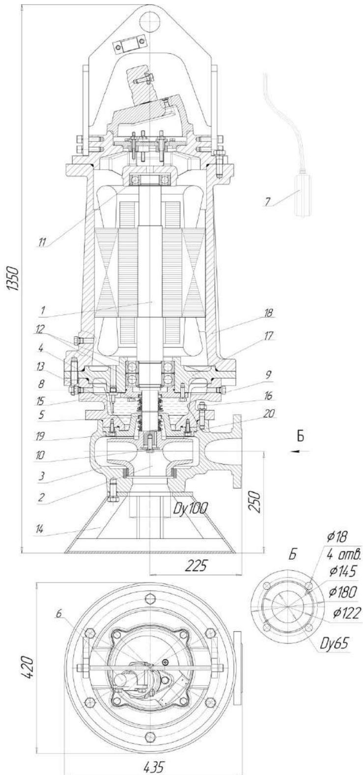
Рис.45 Общий вид, габаритные и присоединительные размеры электронасоса
