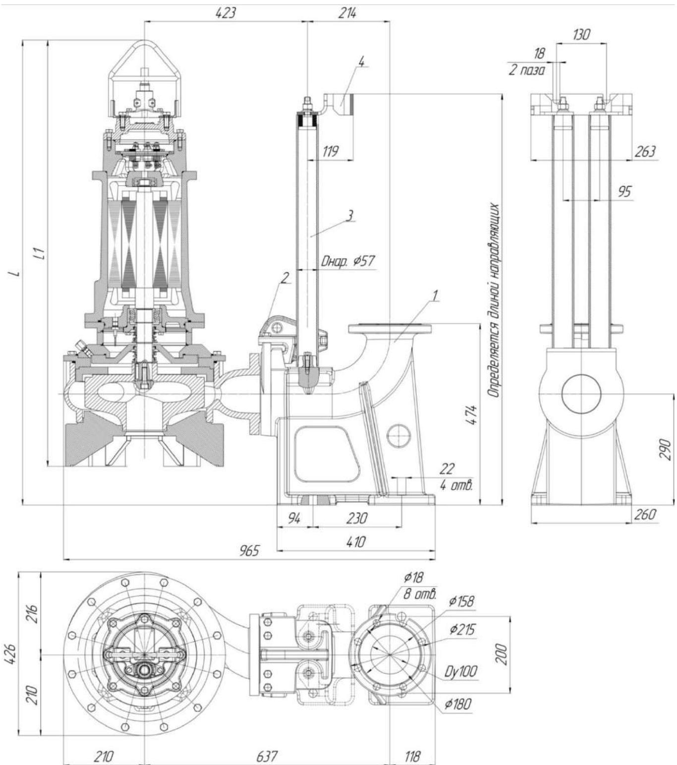
Рис.69 Общий вид и габаритные размеры
