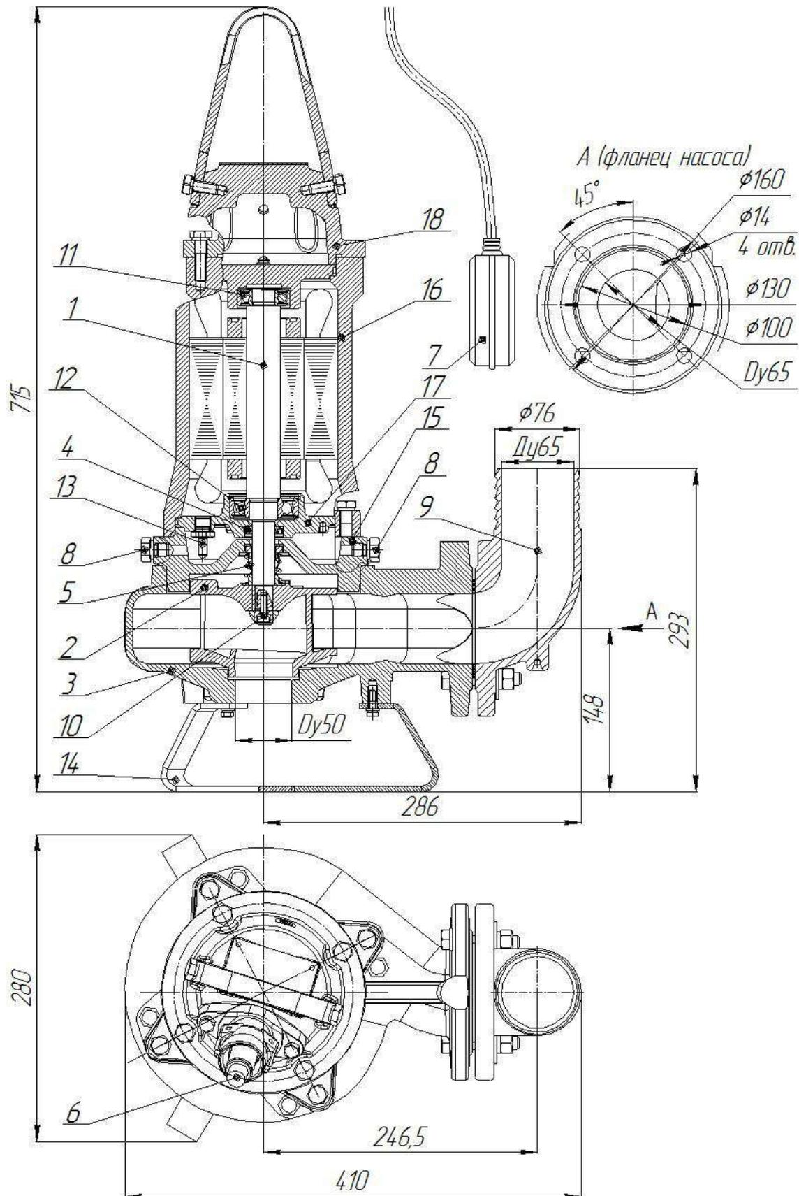
Рис.33 Общий вид, габаритные и присоединительные размеры электронасоса
