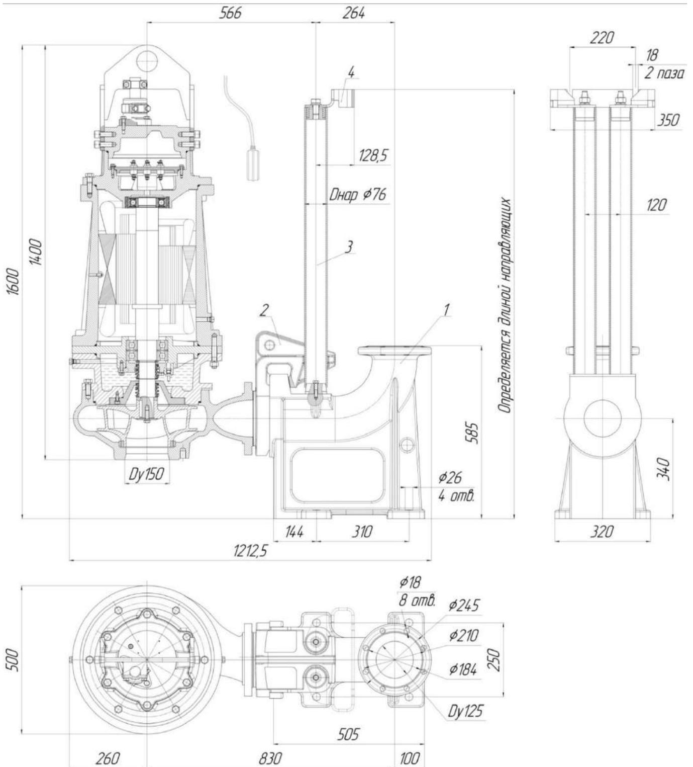
Рис.77 Общий вид и габаритные размеры электронасоса “Иртыш”
