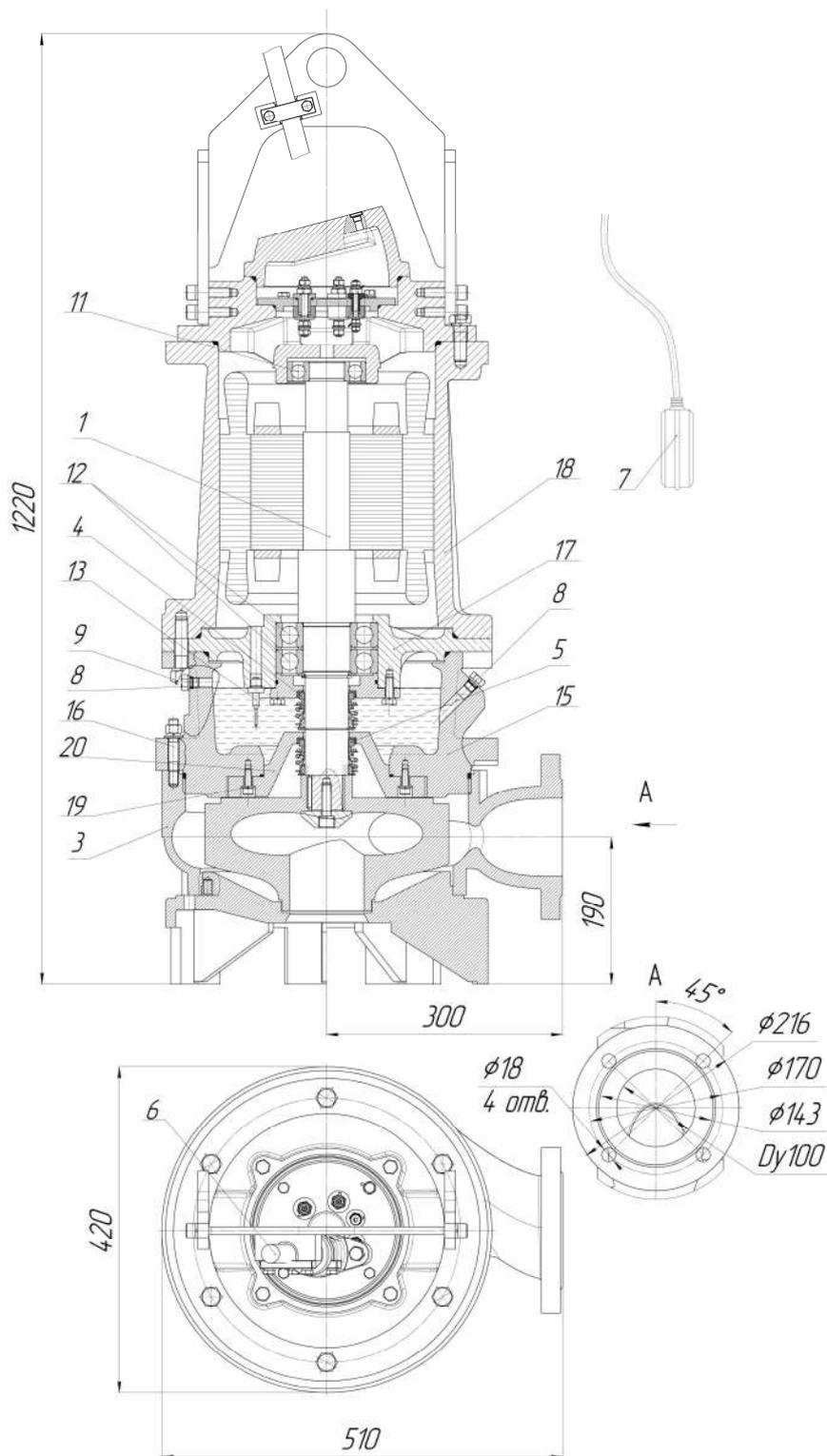
Рис.70 Общий вид, габаритные и присоединительные размеры электронасоса
