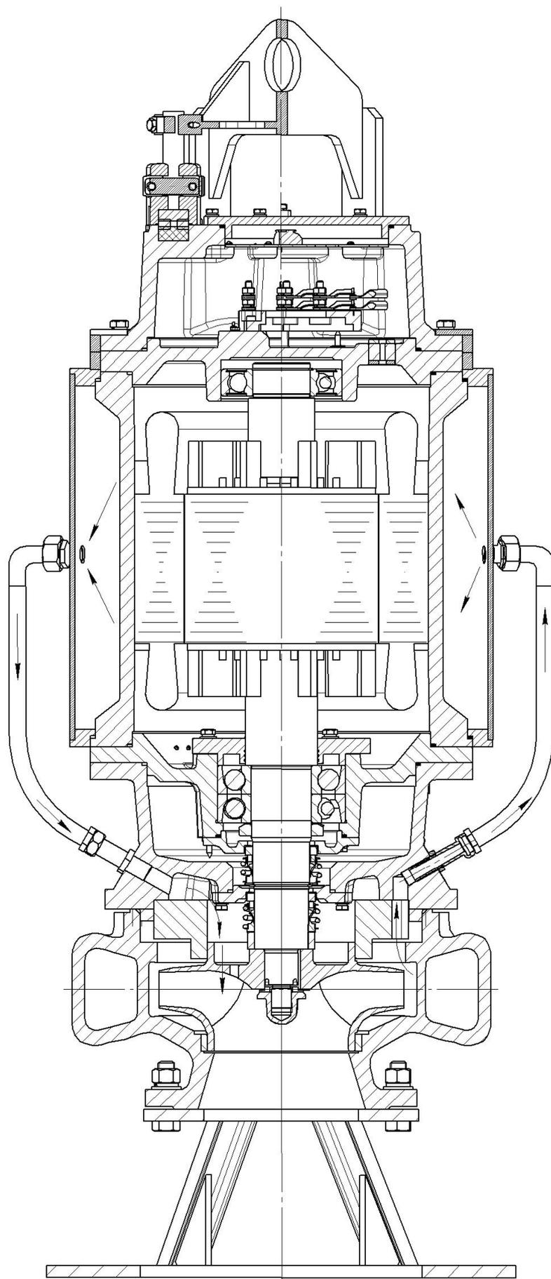
Рис. 7. Принцип работы рубашки охлаждения электронасоса «Иртыш»
