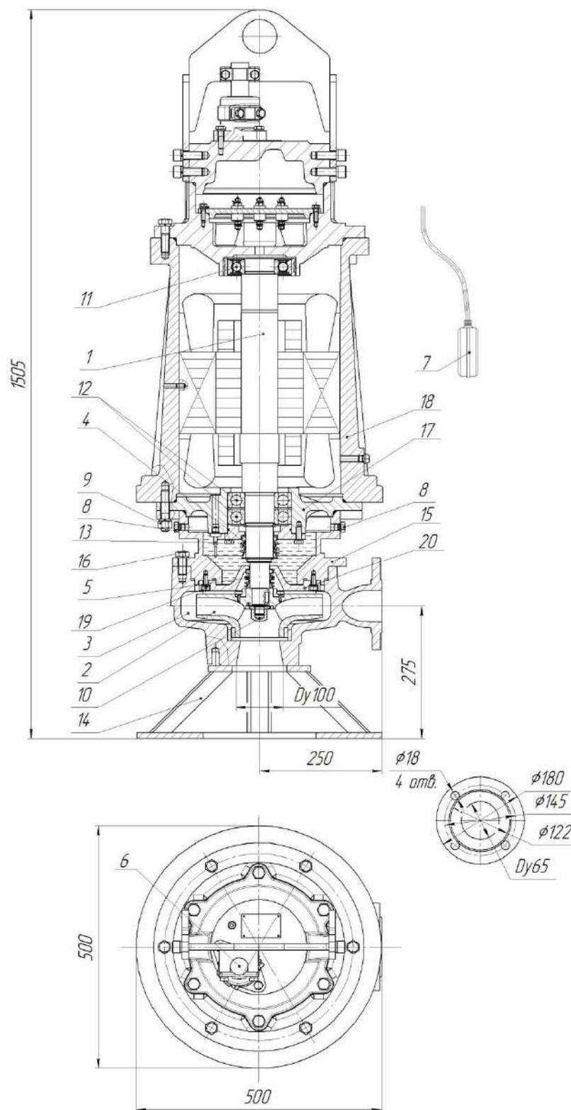
Рис.41 Общий вид, габаритные и присоединительные размеры электронасоса
