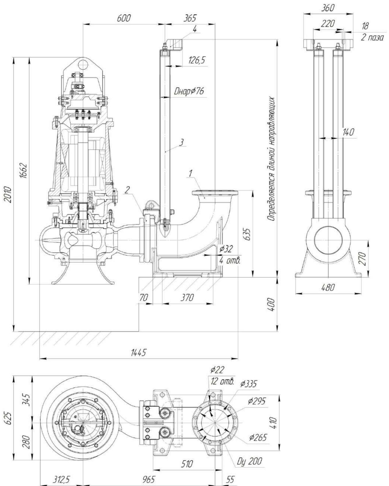
Рис.101 Общий вид и габаритные размеры электронасоса “Иртыш”
