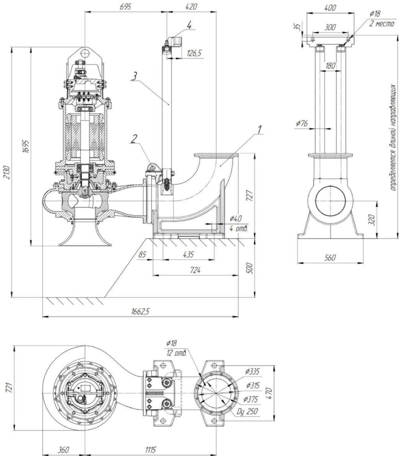
Рис.105 Общий вид и габаритные размеры электронасоса “Иртыш”
