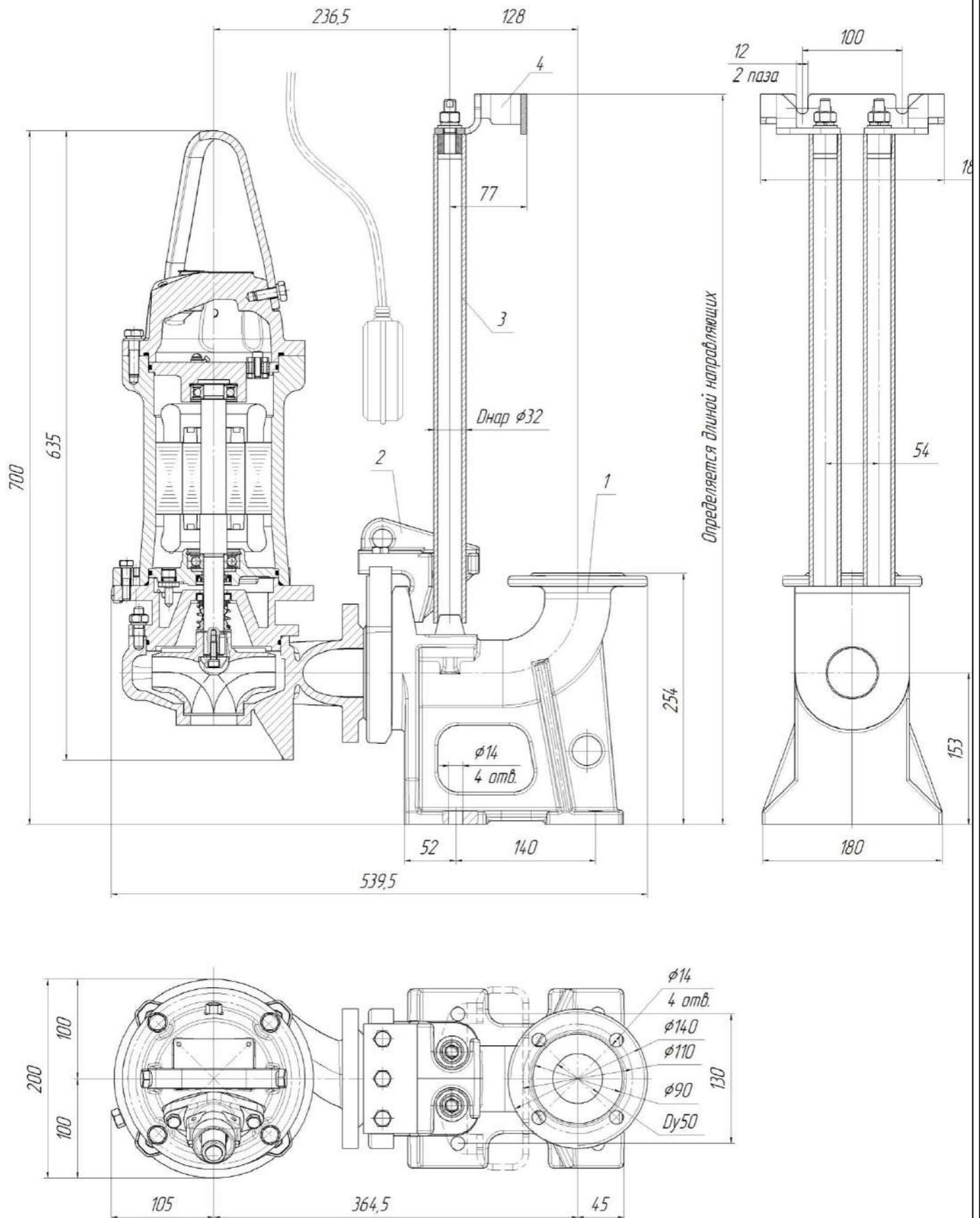
Рис.14 Общий вид и габаритные размеры электронасоса
