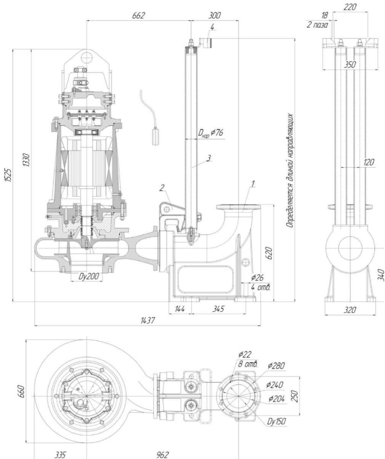
Рис.91 Общий вид и габаритные размеры электронасоса "Иртыш"
