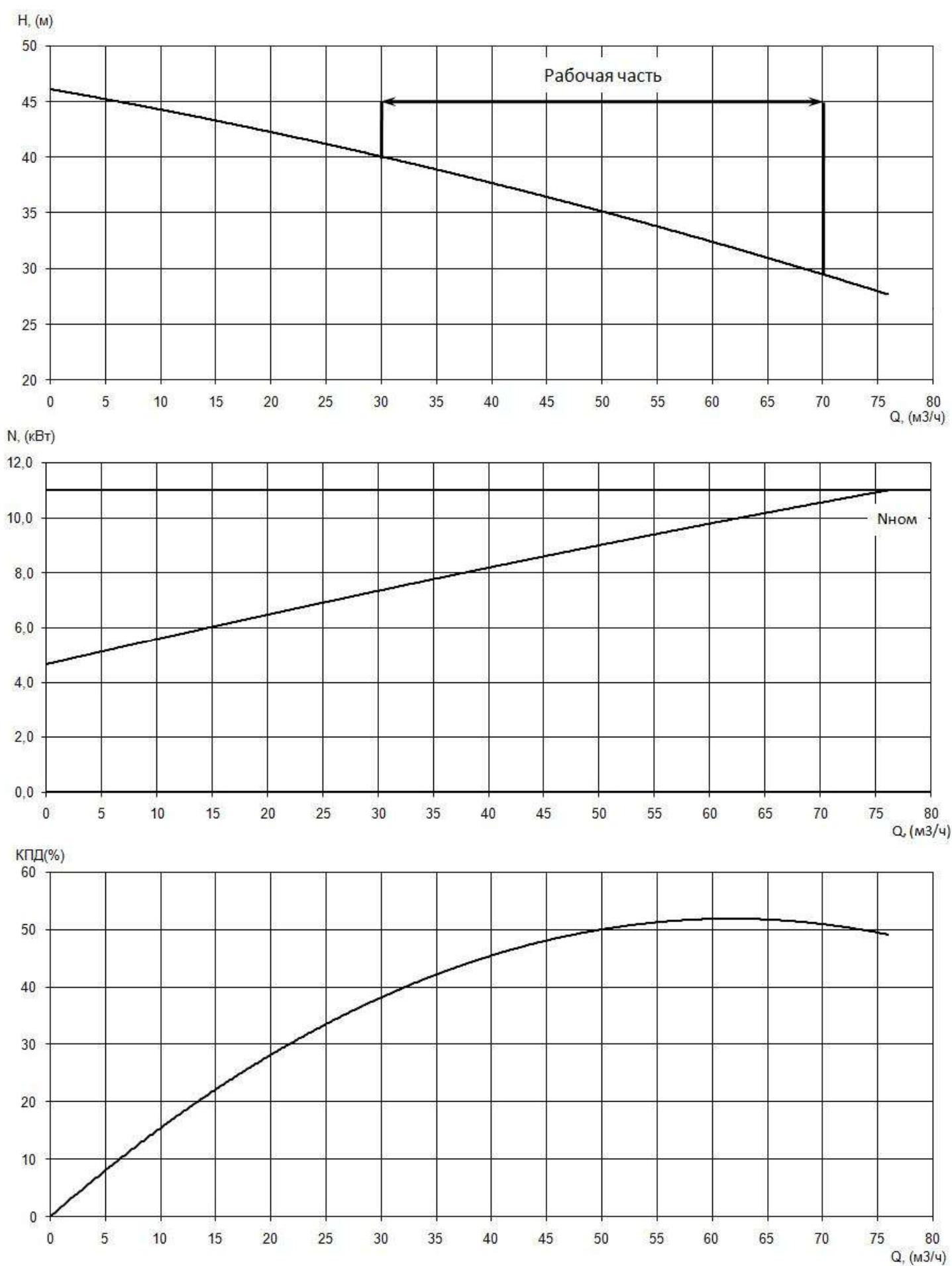
Рисунок 1. - Пример характеристики электронасоса серии «Иртыш»
