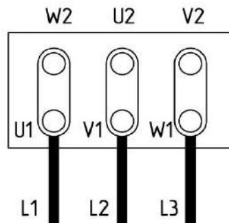
Рисунок 4. - Схемы подключения питания для трехфазного асинхронного электродвигателя
