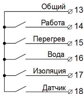
Рисунок 2 - Схема выходов дублирования индикации.
