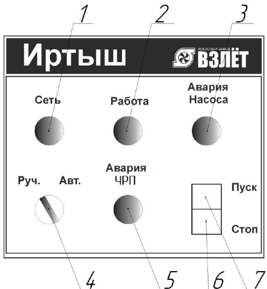
Рисунок 1 – Органы управления и индикации шкафа управления
