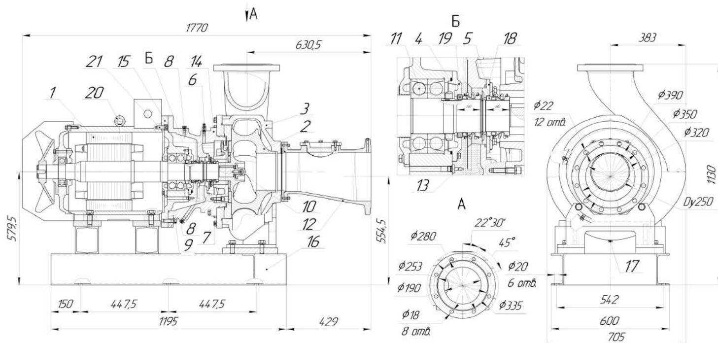
Общий вид и габаритные размеры электронасоса серии «Иртыш»
