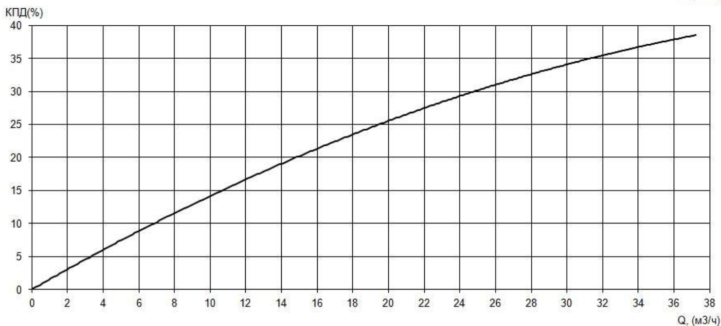
Рабочие характеристики насоса серии «Иртыш» ПФс 50/200.163-7,5/2Ех
