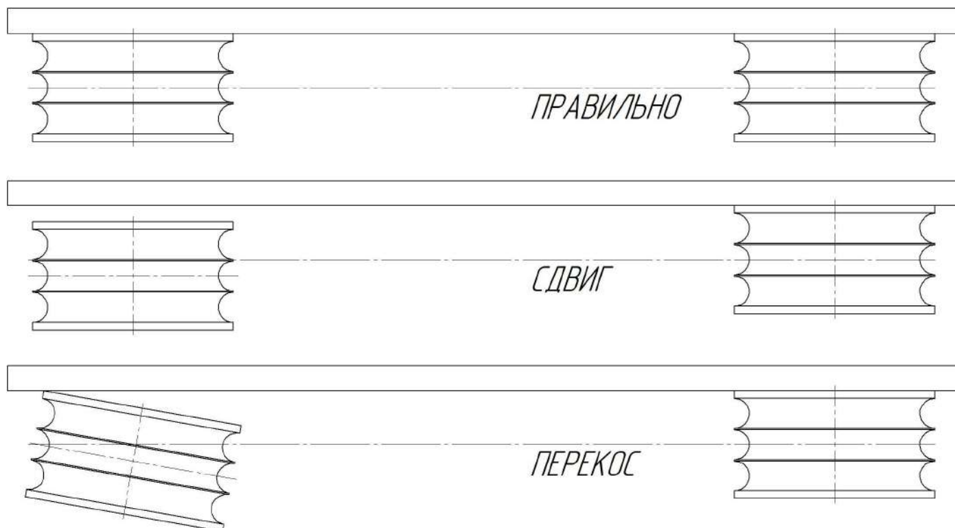
Рисунок 10 – Центровка шкивов
